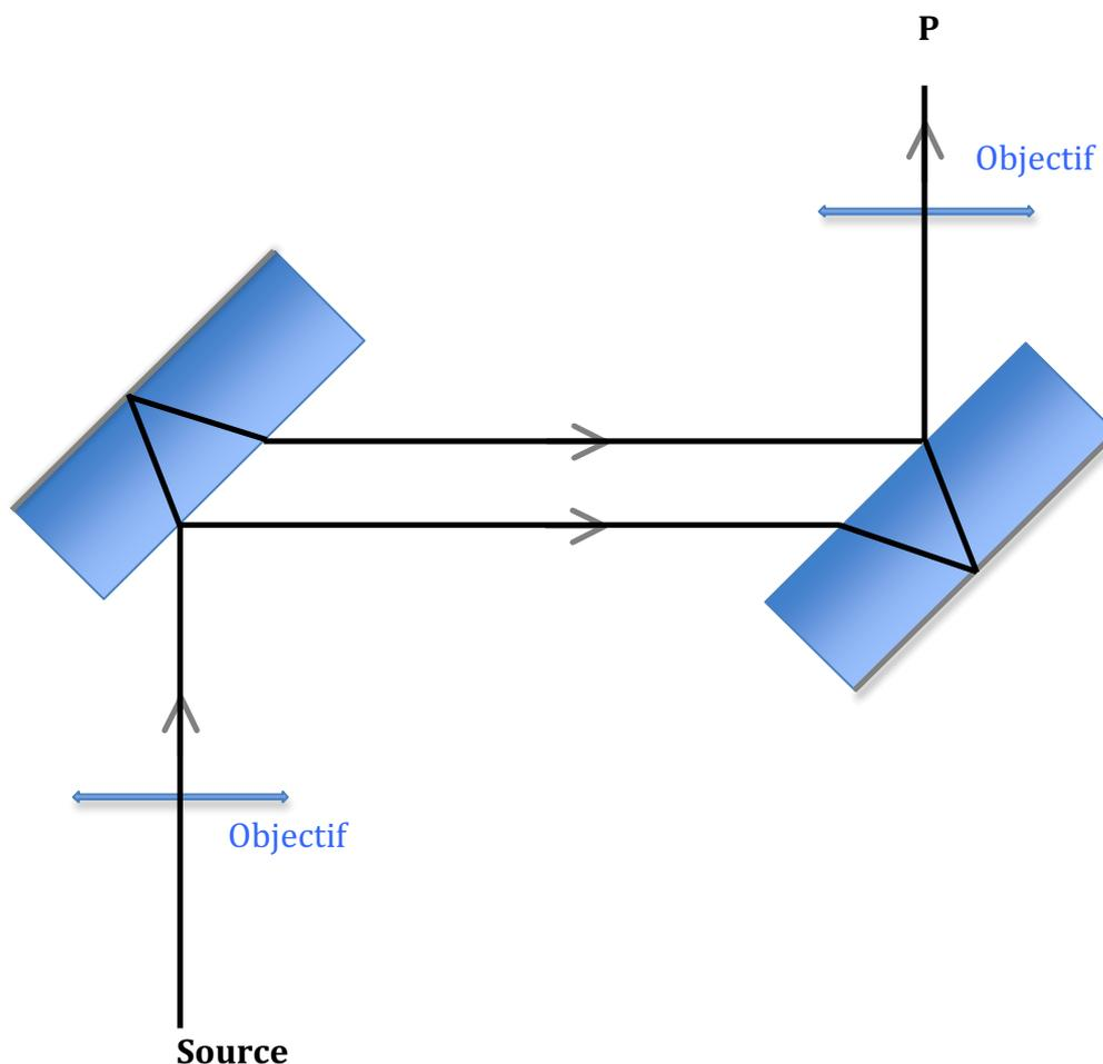
Figure : Schéma illustrant le trajet des rayons lumineux interférant sur un écran placé en position (P). Les rayons lumineux parasites n'ont pas été représentés sur le schéma.
