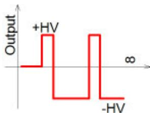
Le passage de - HV à + HV ainsi que celui de + HV à - HV est piloté par un signal TTL.
