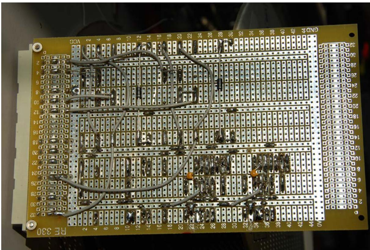
Dans un second temps, nous avons développé une électronique de surveillance automatique de polarité des tensions appliquées aux BNC +HV et -HV.
