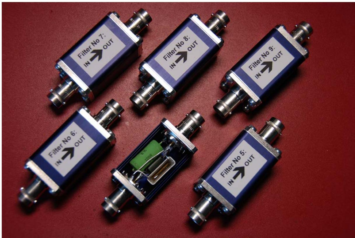
L'usage du filtre LRC série permet d'obtenir un signal parfait comme ci-dessous. Tensions commutées : +- 300 Vdc. Les temps de montées et descente sont de l'ordre de 200ns dus à la présence du filtre notamment. Ces temps sont conformes au cahier des charges initial.
