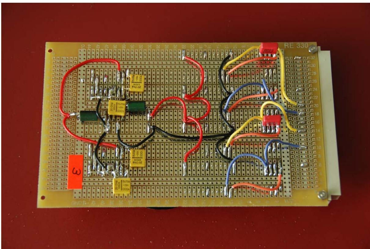
Les signaux de commandes utilisent du câble blindé depuis la face avant jusqu'à la porte 74F04PC. Ces circuits logiques disposent de leur propre alimentation de 5V avec masse indépendante.
