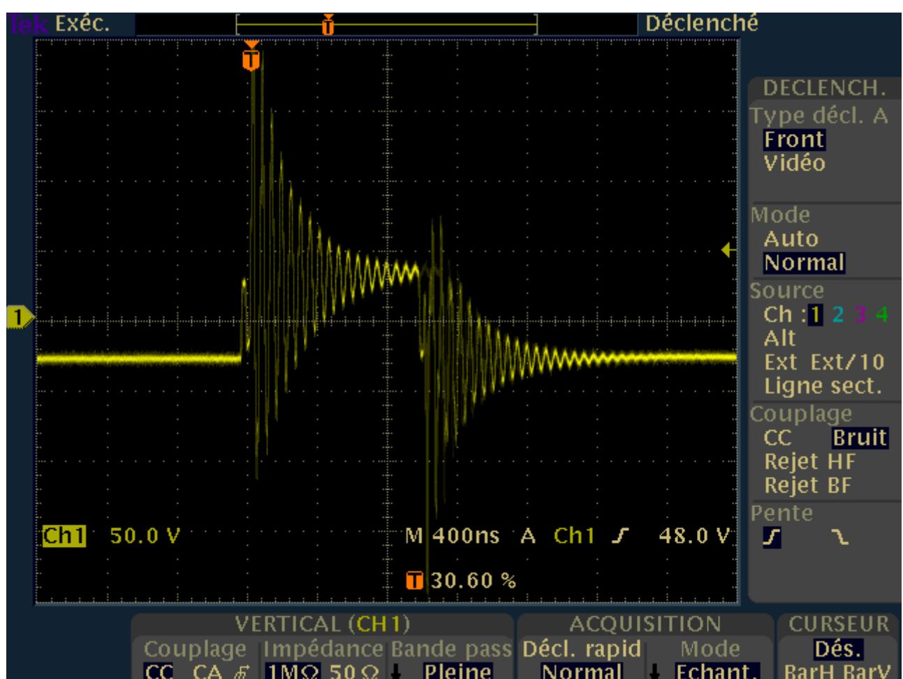
Dans cet exemple : les tensions +HV et -HV étaient de +- 30V. On constate que la surtension passe à +-200V soit 6,6 x plus pendant un temps limité à 1 us.
