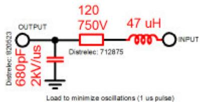
Ce filtre, de type série, offre l'avantage de ne pas consommer d'énergie. La self est constituée d'une simple boucle dans un noyau en ferrite. Son rôle est particulièrement efficace pour supprimer les oscillations.
