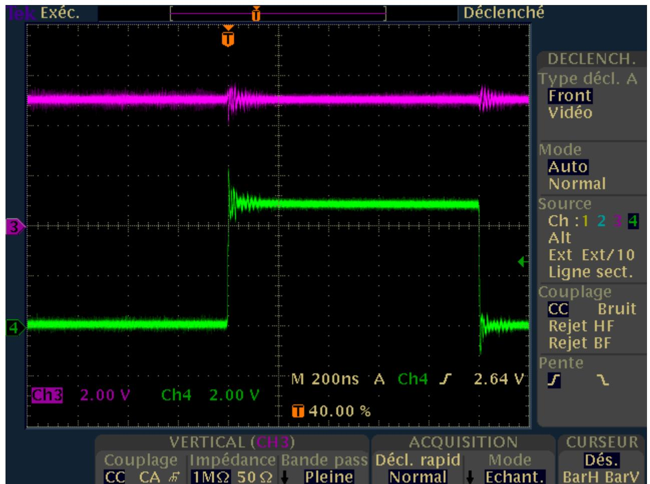
Pulse de 1 us appliquée avec générateur BNC Model 555 Pulse/Delay generator sur proto cartes blanches. En violet, le +5V de l'alim. Pas de commutation en sortie !!!
