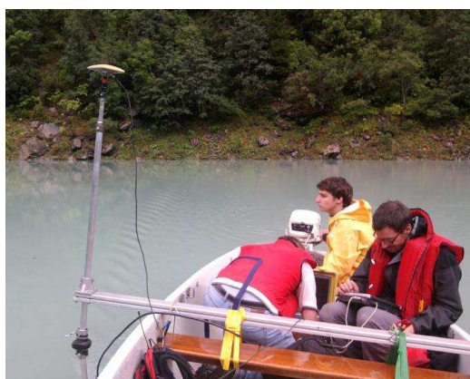
Travaux de bathymétrie (mesure de profondeurs d'un lac par échosondeur).
