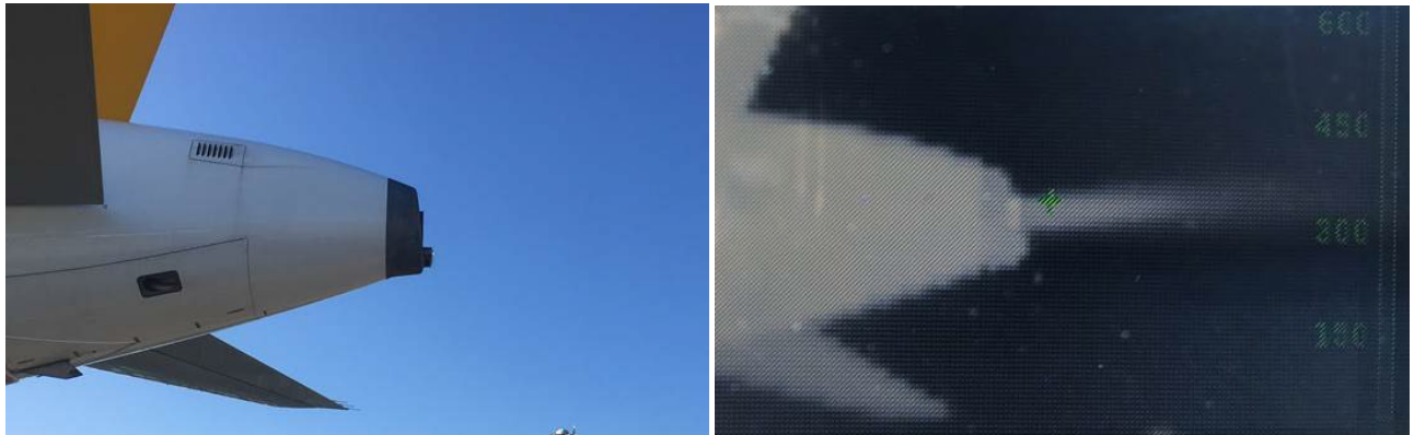
Figure 1: Image thermique d'un GAP et de ses émissions gazeuses à l'arrière d'un avion à l'aéroport de Bâle-Mulhouse
