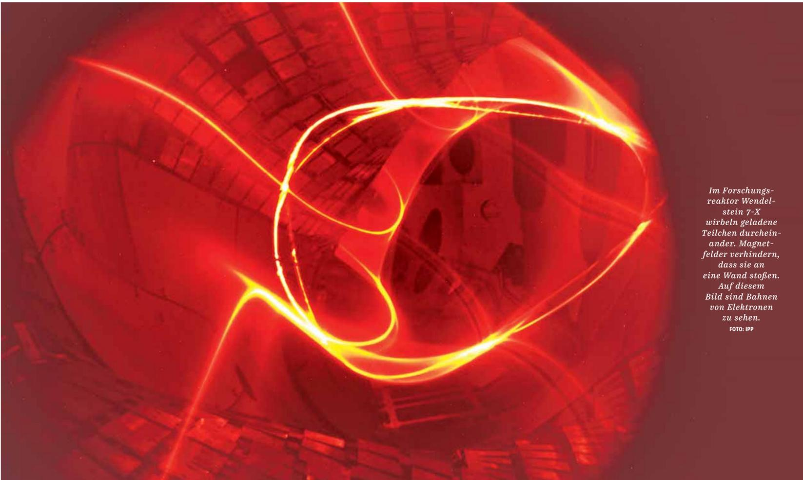
Im Forschungsreaktor Wendelstein 7-X wirbeln geladene Teilchen durcheinander. Magnetfelder verhindern, dass sie an eine Wand stoßen. Auf diesem Bild sind Bahnen von Elektronen zu sehen. FOTO: IPP
