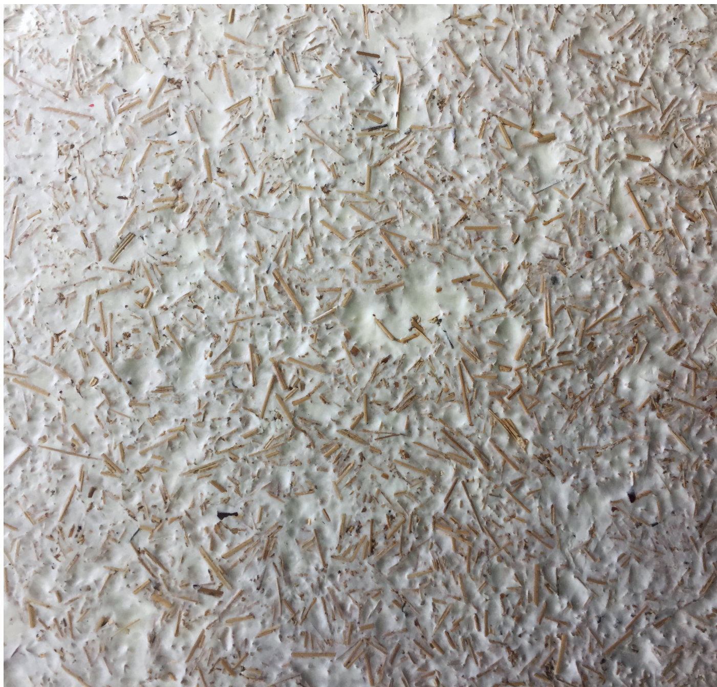
texture du mycelium en mélange avec le substrat
