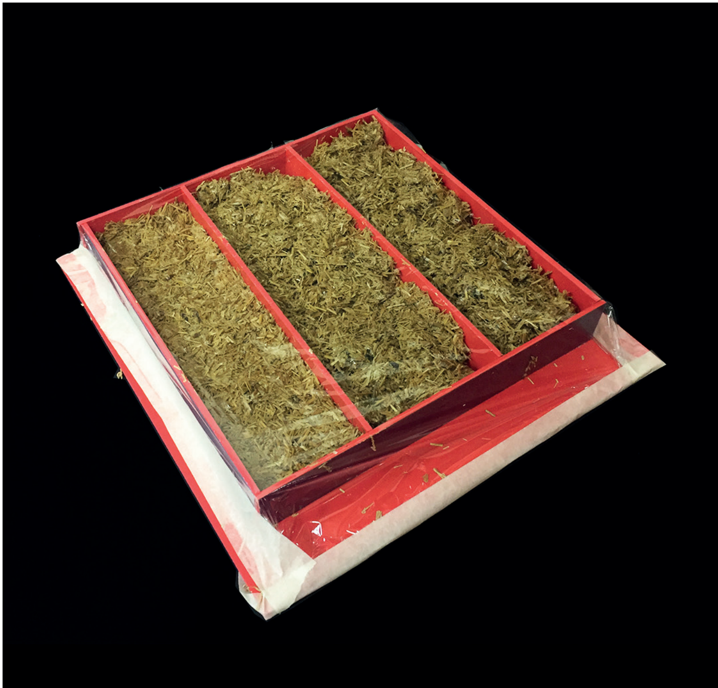
moule standard pour tester la réaction à la compression de la matière dans le moule
