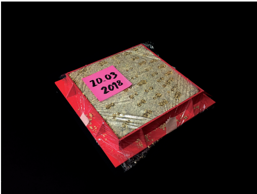
moule standard pour test thermique
