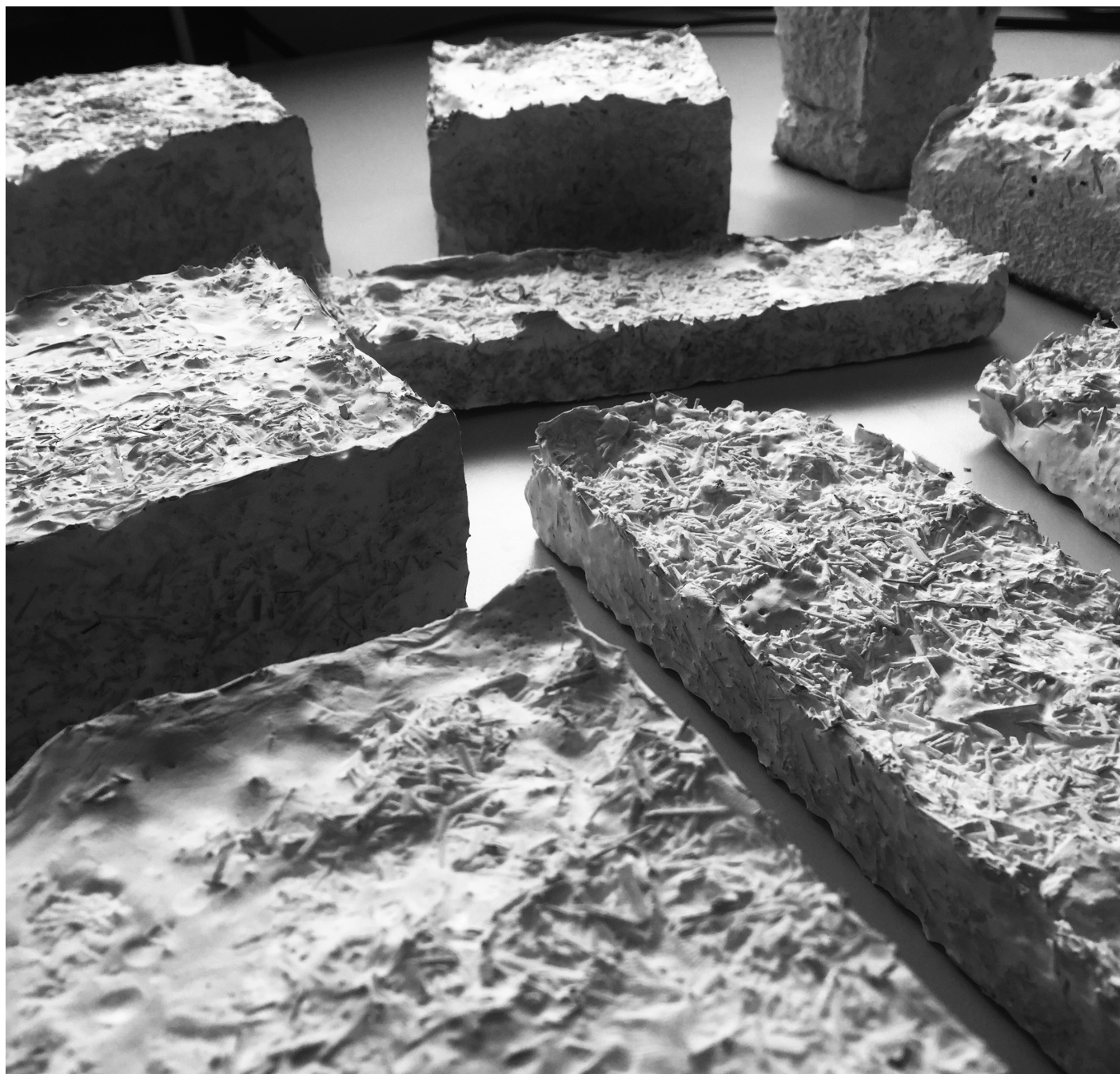
collection de pièces de mycelium après la mise en four
