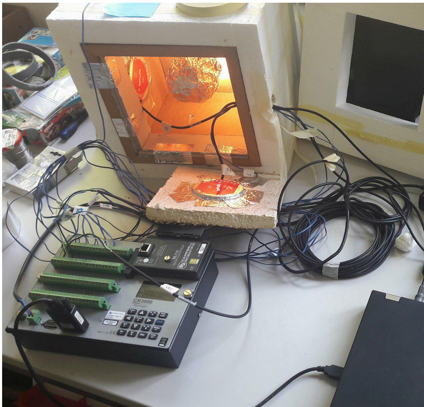
installation pour tester les capacités thermiques du matériau
