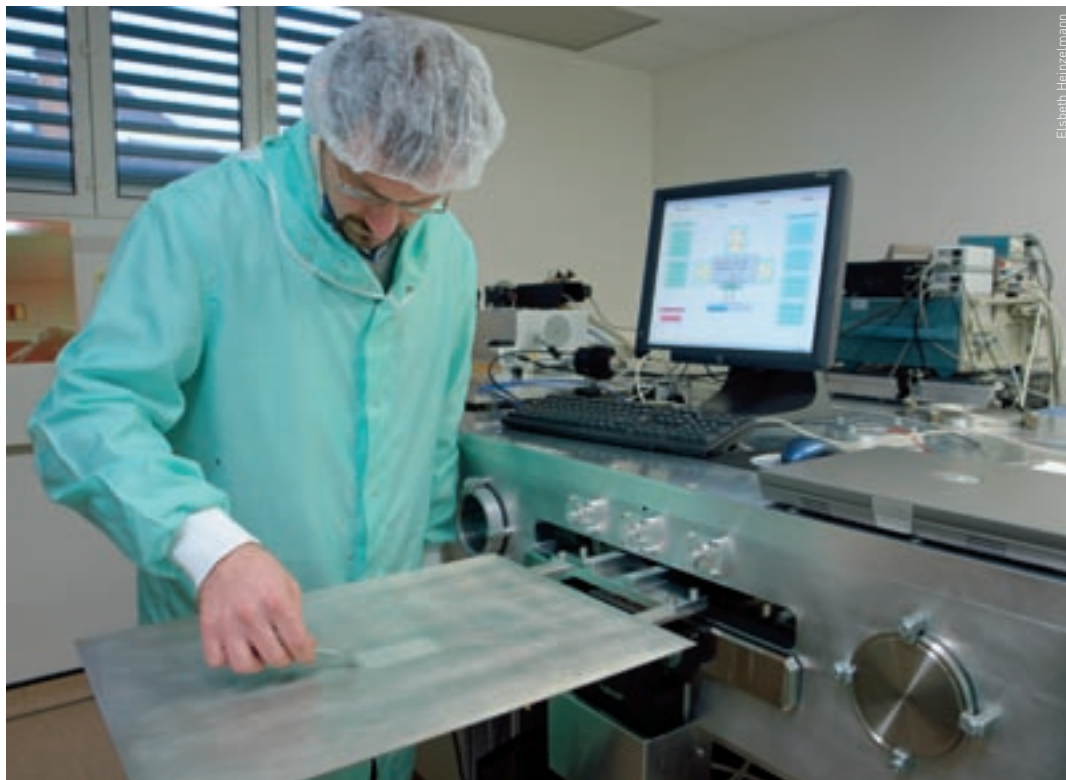
Ladung von Glassubstraten in einen halbindustriellen Abscheidungsreaktor am IMT/EPFL zur Entwicklung von Dünnschicht-Zellen aus mikrokristallinem Silizium.
