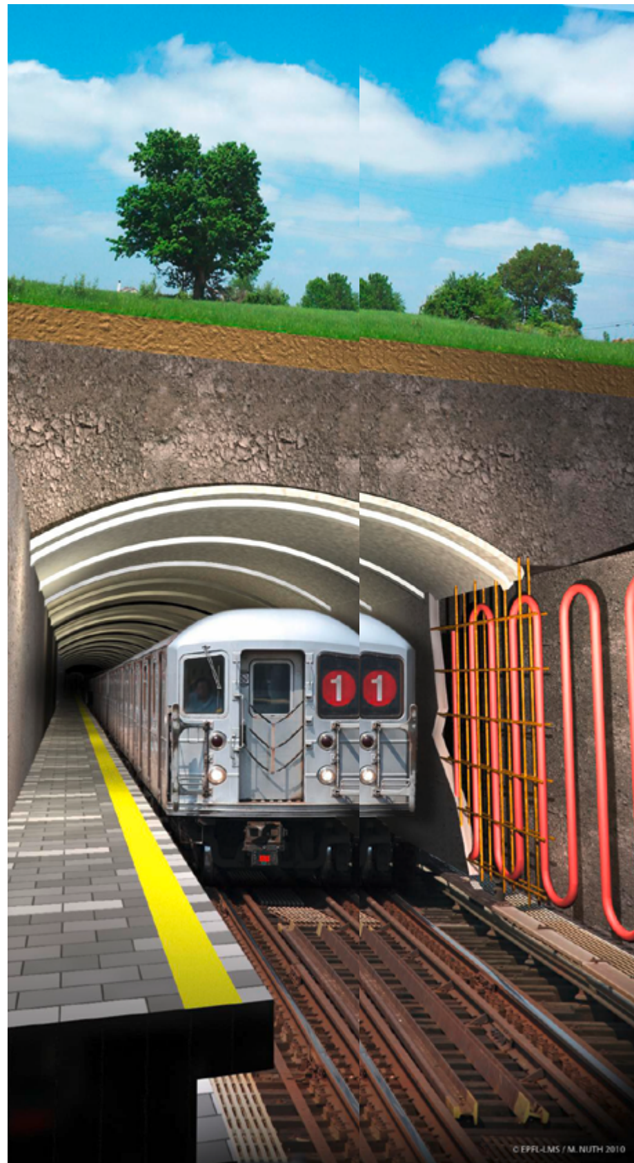
Schematische Darstellung des U-Bahntunnels mit Wärmetauscherrohren in der Tunnelinnenwand zur Rückgewinnung von Erdwärme und Konvektionswärme aus der Luft.
