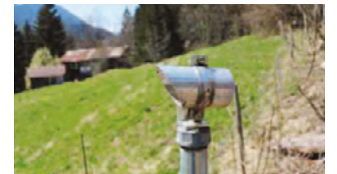
Le terrain n'est pas seul à descendre. Avec lui, les marques apposées par l'homme, mais aussi la chaussée et les cibles du système de surveillance continue du glissement.
