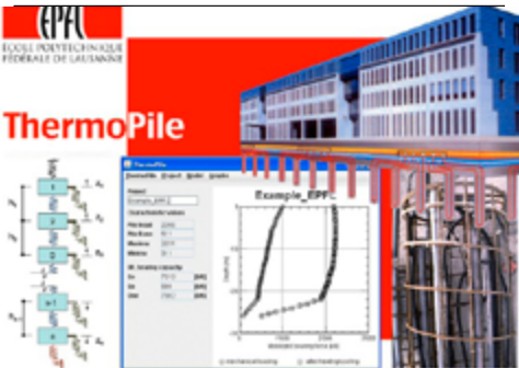
>> ThermoPile separiert einzelne Pfahlsegmente und berücksichtigt damit unterschiedliche Bodenverhältnisse.
