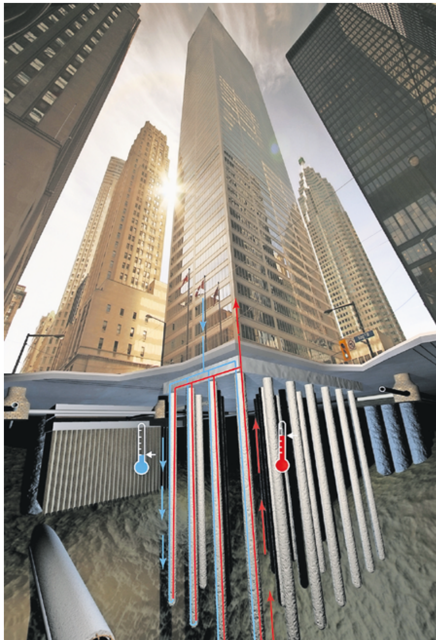
La géostructure énergétique prend appui sur les fondations des bâtiments pour capter la chaleur du sol sous-jacent et l'utiliser pour chauffer ou rafraîchir l'édifice. EPFL/IMAGE DE SYNTHÈSE
