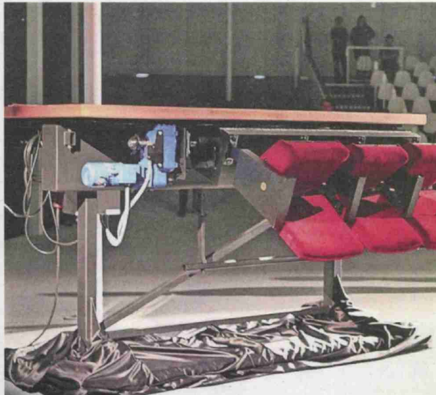
La plupart des sièges du centre peuvent s'escamoter sous le sol en quelques minutes. DR
