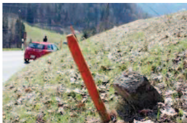
Le terrain n'est pas seul à descendre. Avec lui, les marques apposées par l'homme, mais aussi la chaussée et les cibles du système de surveillance continue du glissement.
