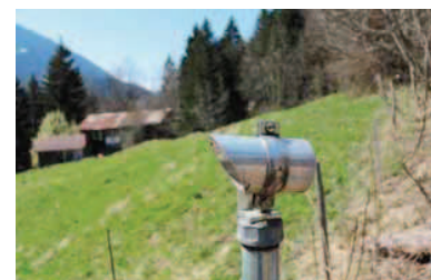
Le terrain n'est pas seul à descendre. Avec lui, les marques apposées par l'homme, mais aussi la chaussée et les cibles du système de surveillance continue du glissement.
