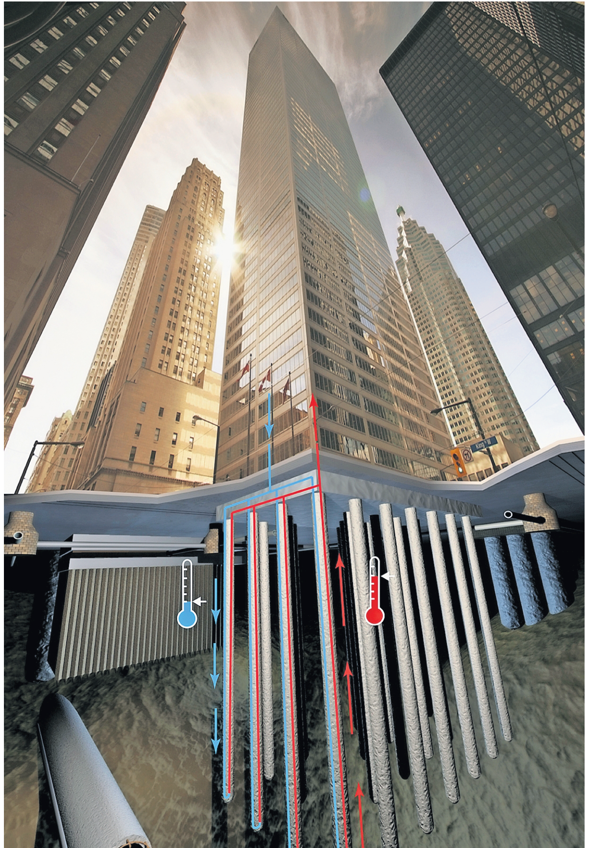
La géostructure énergétique prend appui sur les fondations des bâtiments pour capter la chaleur du sol sous-jacent et l'utiliser pour chauffer ou rafraîchir l'édifice. EPFL/IMAGE DE SYNTHÈSE
