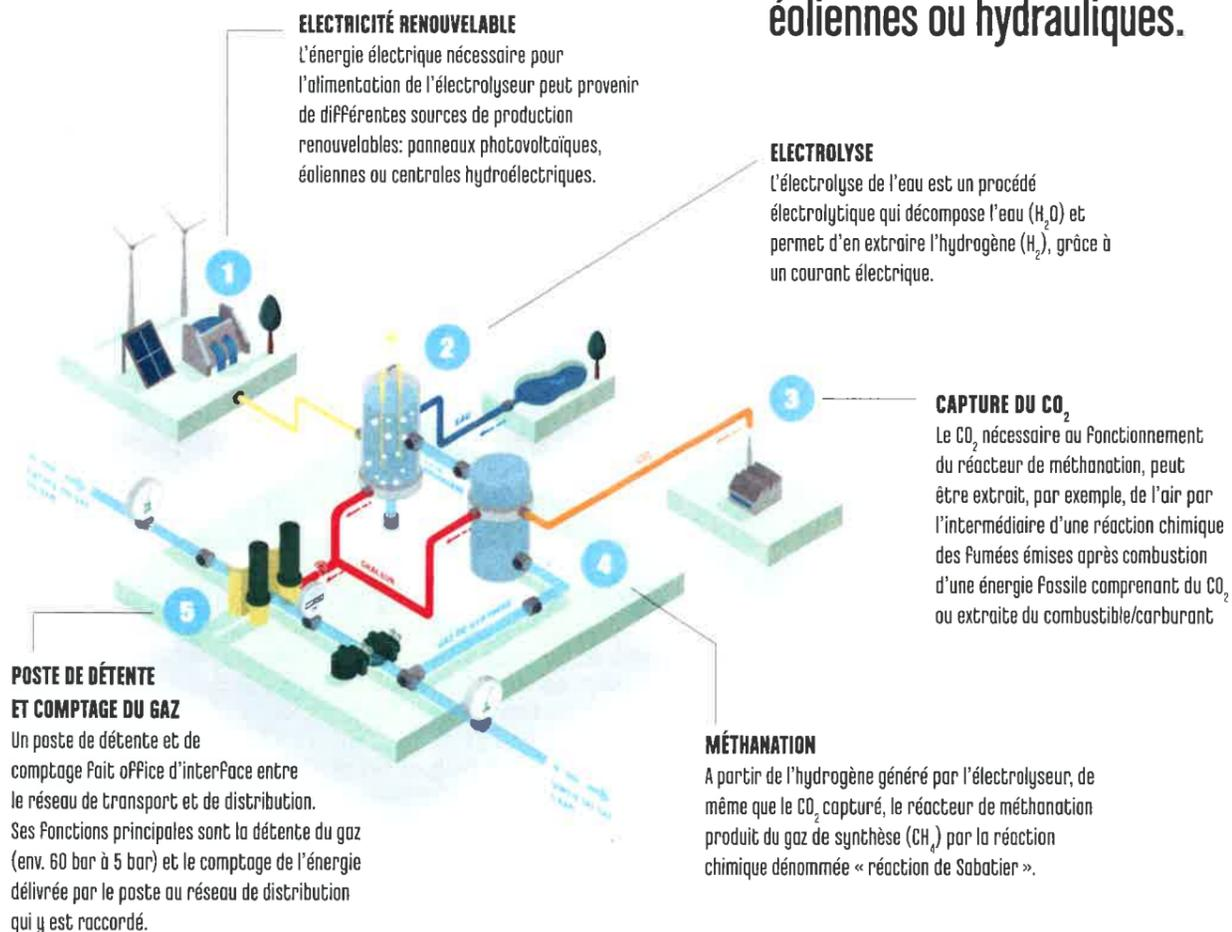
**Le réacteur de méthanation installé dans le PDC de Sion** (voir ci-contre) fonctionne avec un taux de conversion supérieur à 99%. Cela signifie que le
