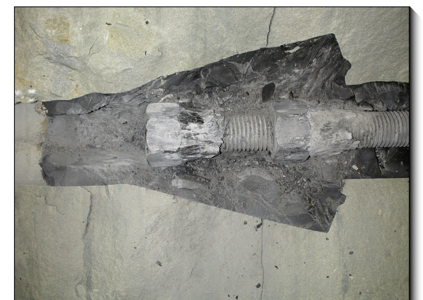
Rupture dans le scellement de la tête d'ancrage
