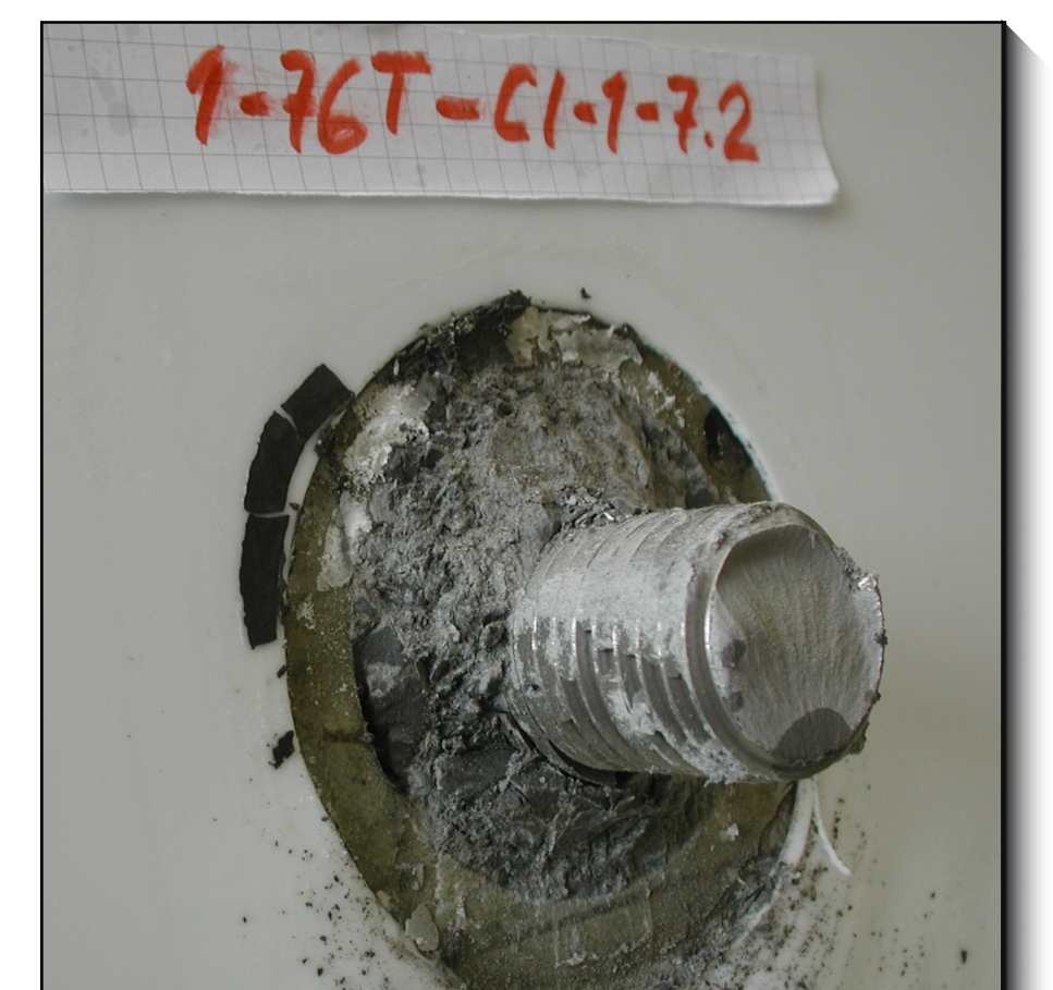
Rupture fragile de la barre de titane
