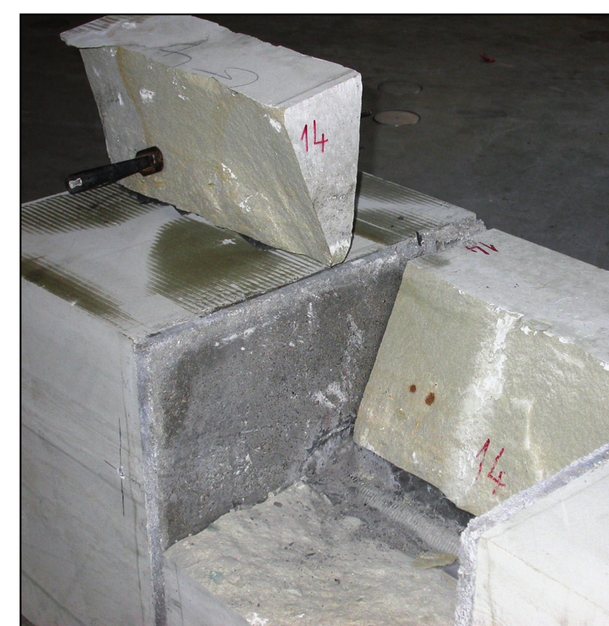
Rupture dans la pierre, acier HTRS
