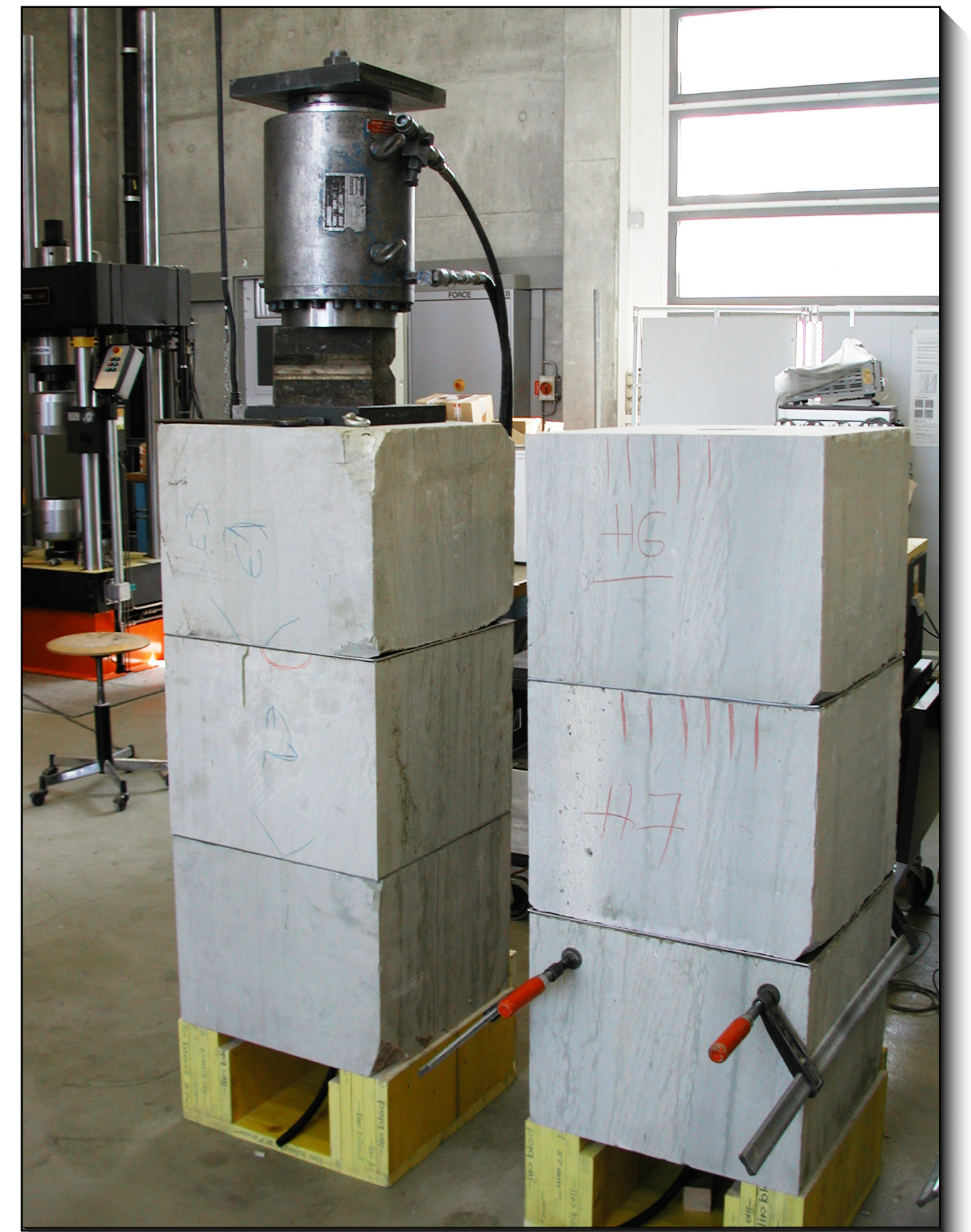
Mise en précontrainte des blocs de pierre
