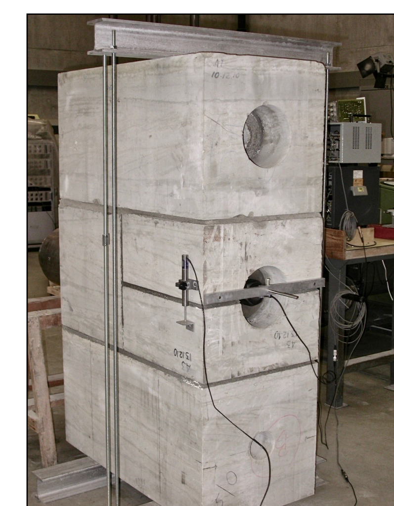
Essai de scellement dans l'axe d'un joint
