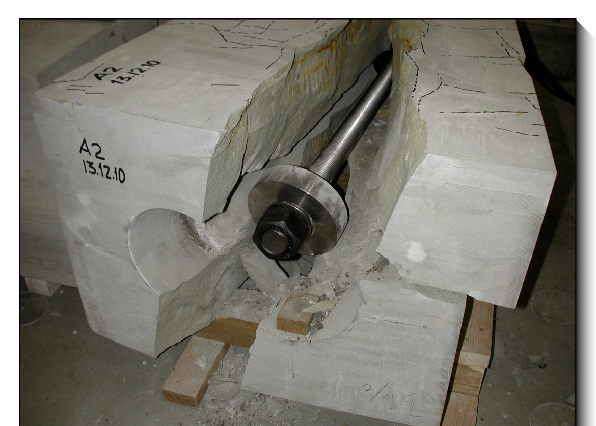
Rupture de la pierre (ancrage sans scellement)
