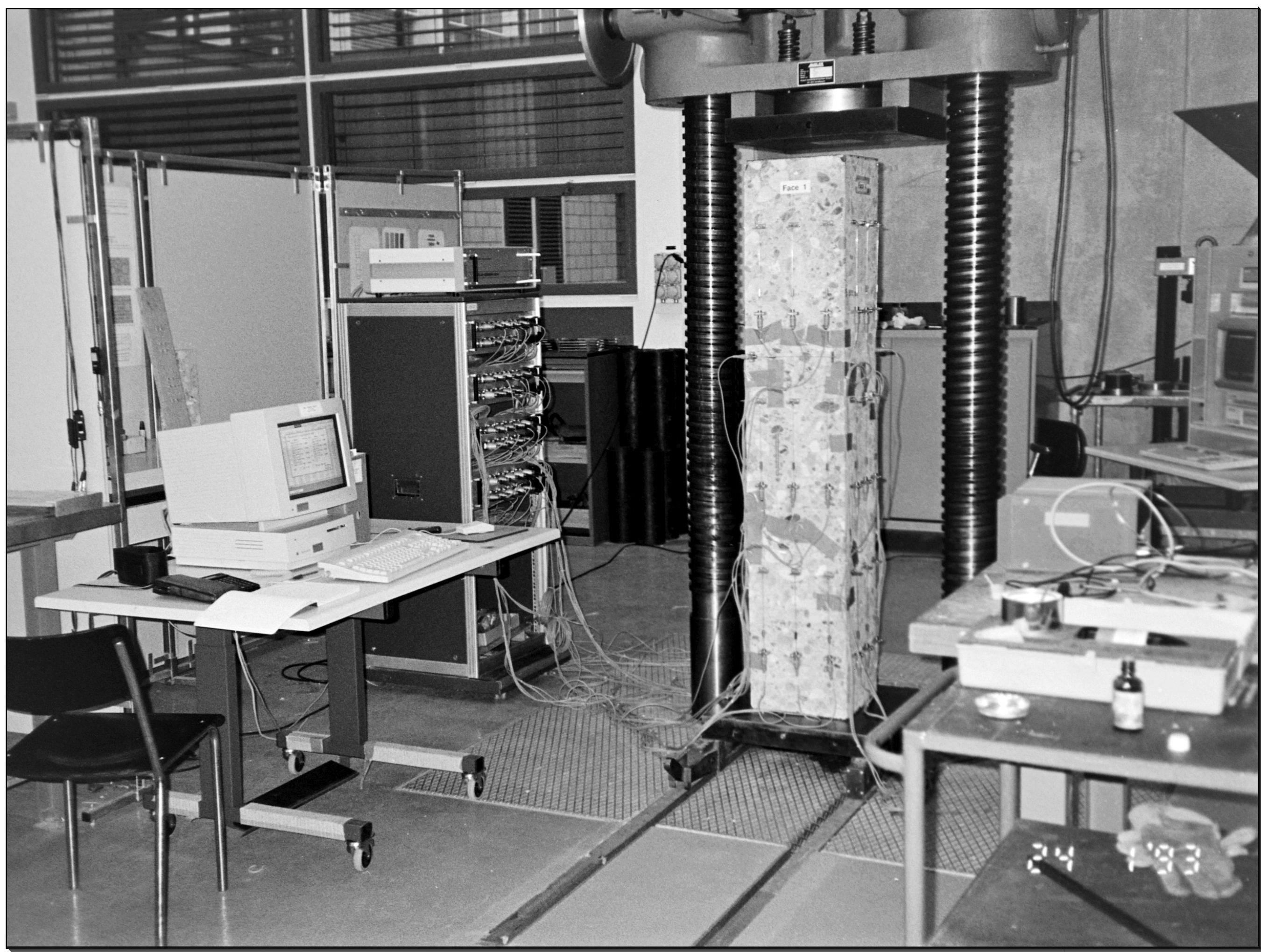
Etude des effets d'échelle et de conditions aux limites de béton (Thèse M. Amieur)
