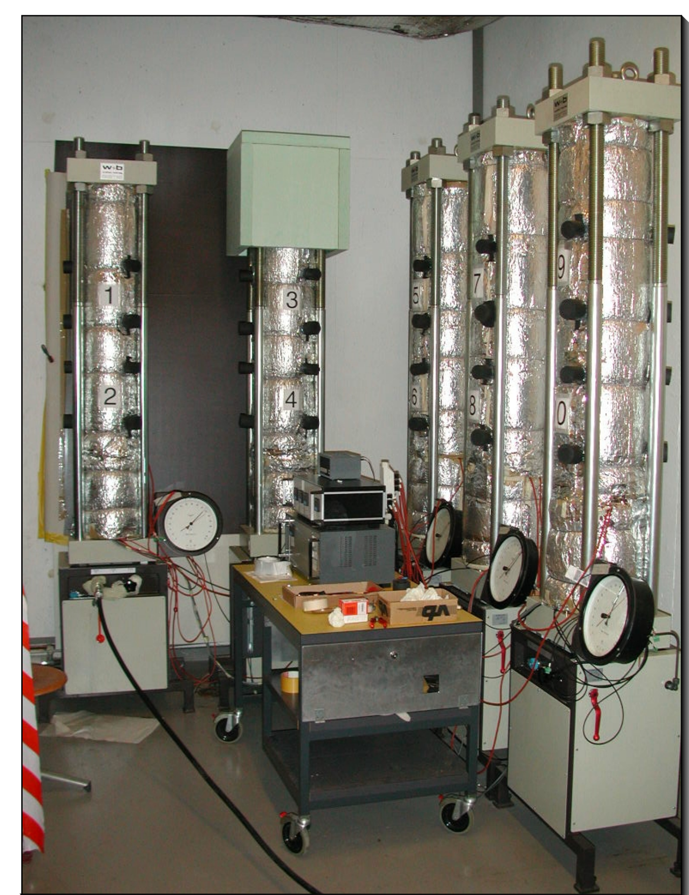
Etude de l'influence de la température sur le fluage de bétons de barrage (Thèse A. Bengougoum)
