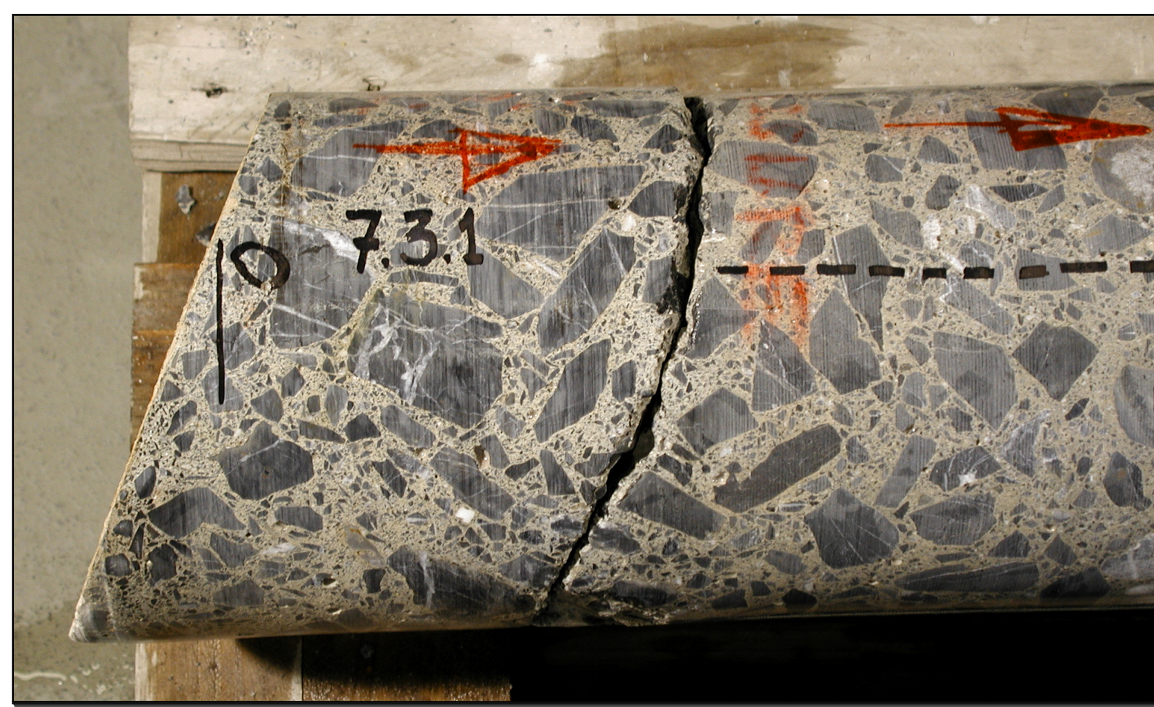
Carotte prélevée dans un barrage, fissurée selon le principe du gel JPD
