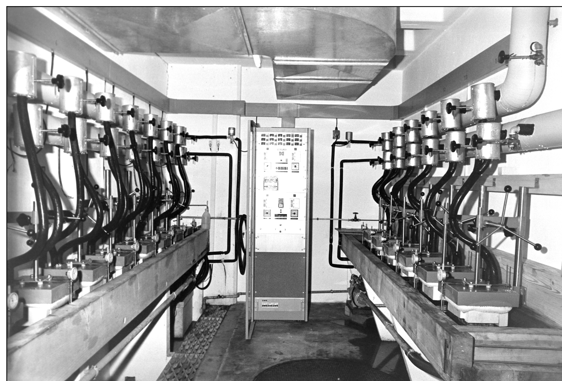
Nouvelle installation automatique de gel-dégel JPD 1974
