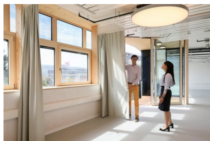
L'intérieur du module SolAce est doté de vitrages très performants et d'un éclairage avec des LED pilotés par un œil électronique. EPFL
