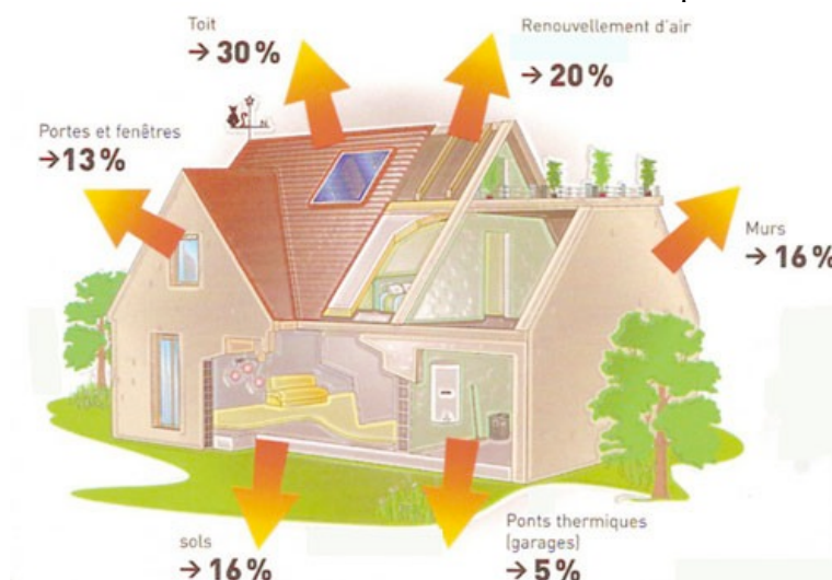
Figure 4.6: Pertes de chaleurs dans une maison typique mal ou non isolée
