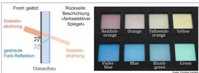
Durch die farbselektive Beschichtung auf der Glasrückseite lässt sich eine bunte Palette erzeugen. (Bild: LESO-PB)
