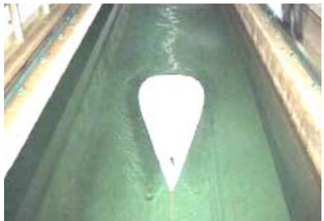
Figure 3: Essai en bassin de carène à l'Office Fédéral des Eaux et de la Géologie (OFEG)
