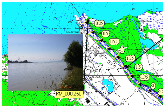
Fig. 3: Interface ArcView® sur fond de carte topographique avec l'identification des profils en travers et des photos du Rhône
