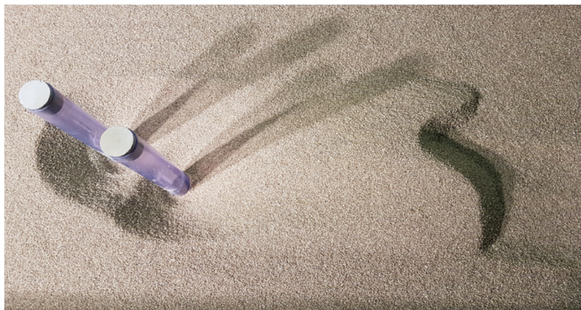
Figure 3: Affouillement d'équilibre des sédiments en fin d'essai ( \theta=30^\circ ).
