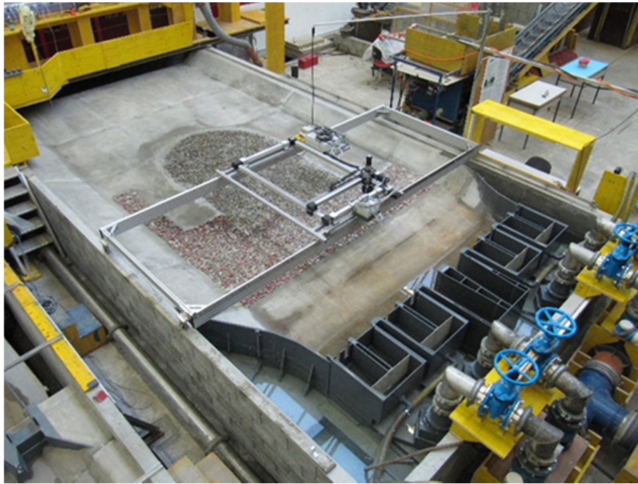
Figure 1: Modèle physique de la centrale hydroélectrique de Rhinau
