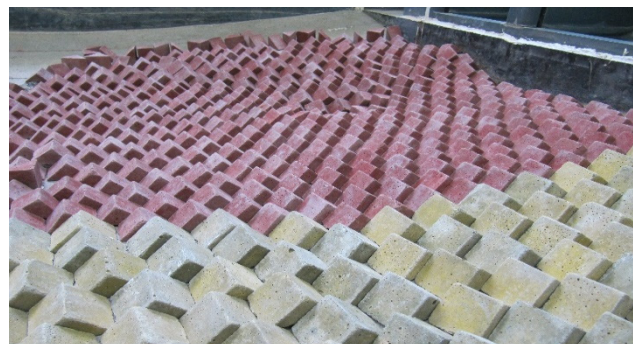
Figure 2: Première couche de blocs telle que placée pour les tests "implementation" / First layer of blocks as placed for the "implementation" tests.
