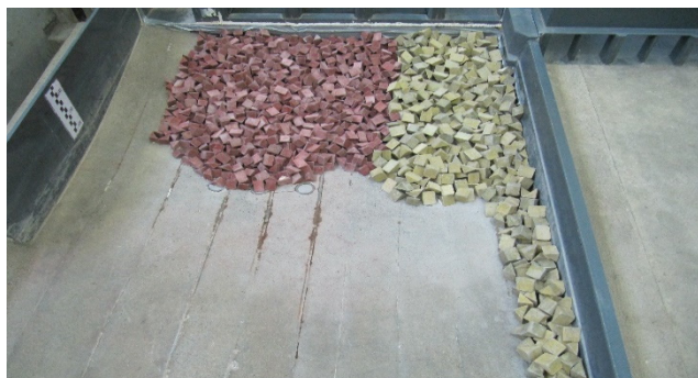
Figure 1: Forme de la solution finale retenue avec blocs rouges (1.8 m) et blocs jaunes (2.2 m) en place / Form of the final solution retained with red blocks (1.8 m) and yellow blocks (2.2 m) in place.
