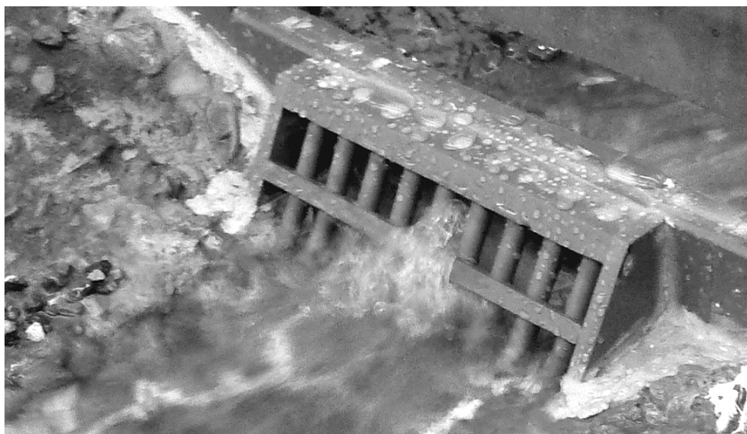
Figure 2: Installation expérimentale avec control mécanique (grille) et control hydraulique en aval (éléments PVC).
