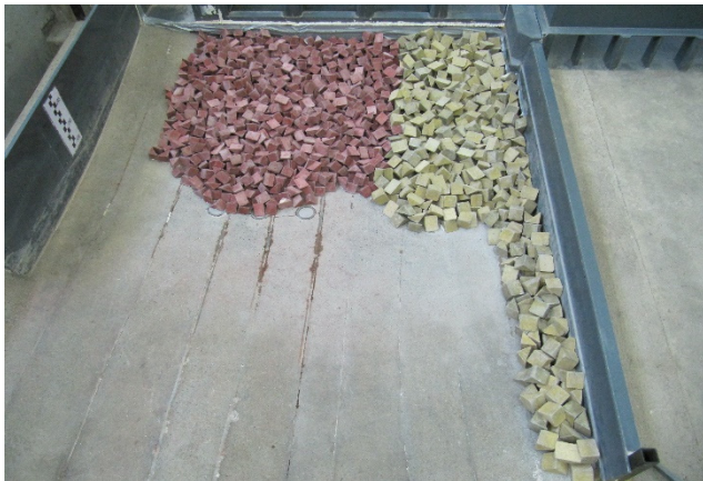
Figure 1: Forme de la solution finale retenue avec blocs rouges (1.8m) et blocs jaunes (2.2m) en place.
