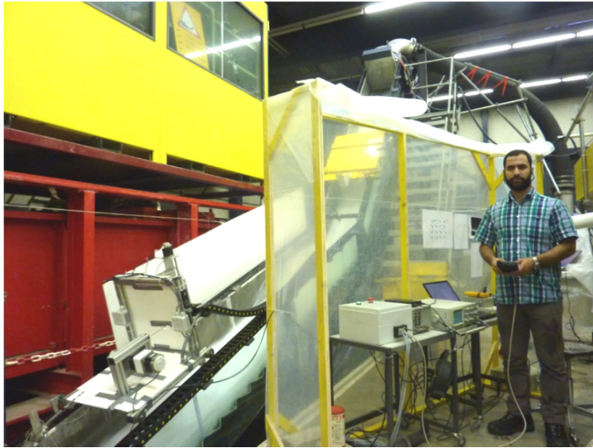
Figure 1: Modèle physique du déversoir en gradins avec un changement de pente abrupte au LCH-EPFL; la double fibre optique est montée sur le système de placement automatique.
