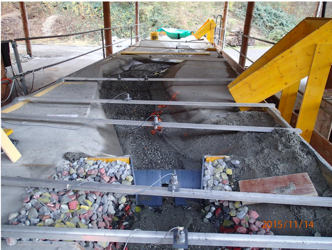
Figure 2 : modèle physique du barrage filtrant
