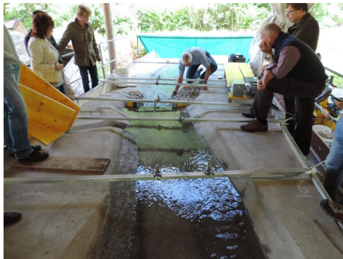
Simulation d'une crue centennale lors de la mise en eau officielle du modèle; au milieu: Jean-Louis Boillat manipule la fosse de dissipation d'énergie du barrage filtrant
