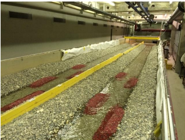
Figure 2: (Gauche) exemple de deux configurations pour le réapprovisionnement en train d'être testées, (droite) instrumentations installés sur le chariot (caméra, laser et ordinateur)
