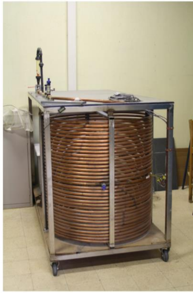
Figure 1 : Configurations expérimentales utilisées pendant la thèse : (gauche) conduite rectiligne en cuivre ; (centre) conduite en bobine en cuivre et (droite) conduite en bobine en polyéthylène
