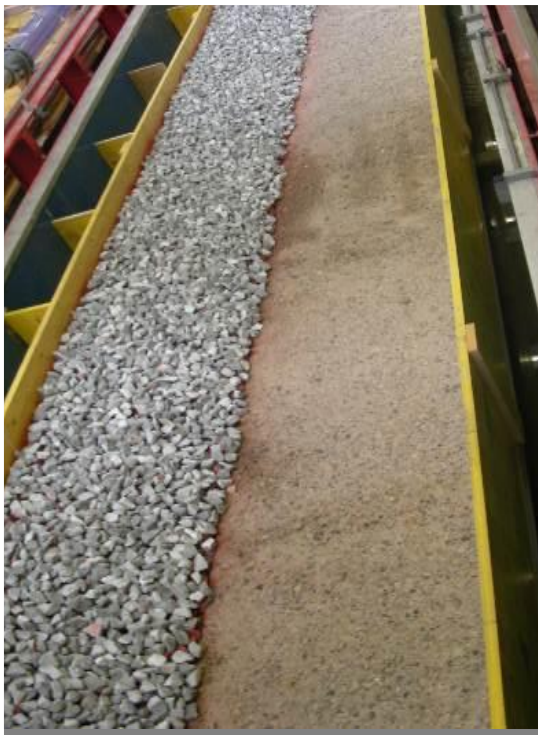
Figure 1 : Exemple montrant la défaillance des enrochements, avant (a) et après (b) le test avec la double couche.
