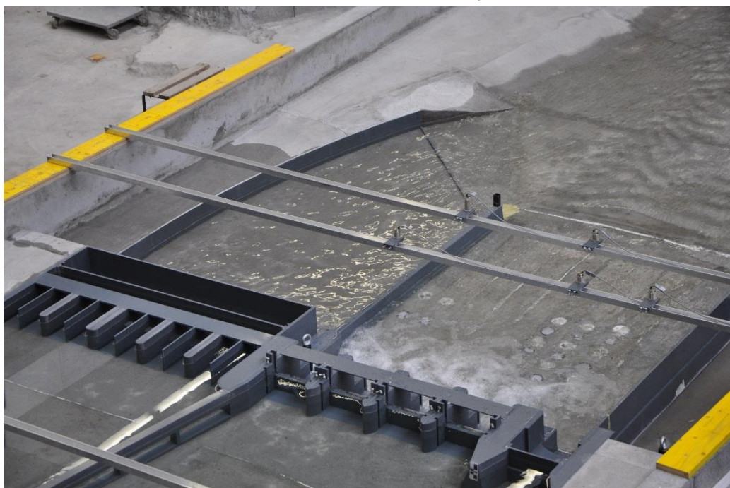
Figure 1 : Vue sur le modèle physique montrant le barrage de Chancy-Pougny avec les capteurs de pression au fond de la fosse ainsi que les sondes à ultrasons en position
