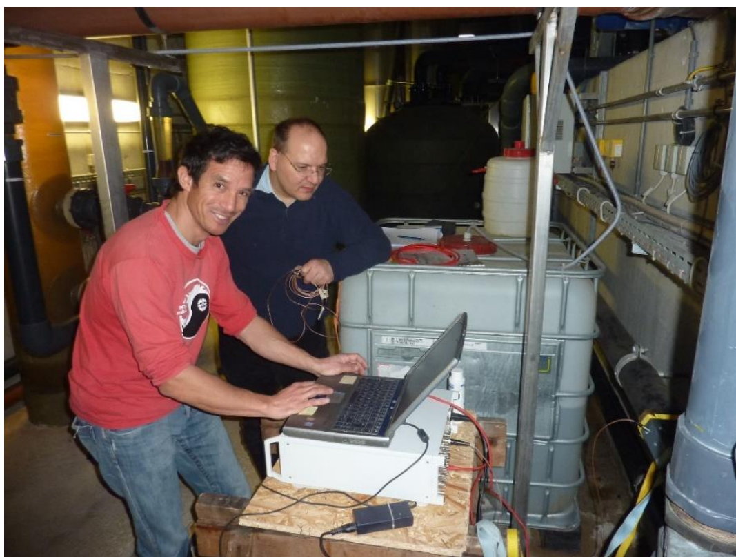
Figure 1 : Mesures de débits in-situ en utilisant le moniteur UVP Met-Flow.
