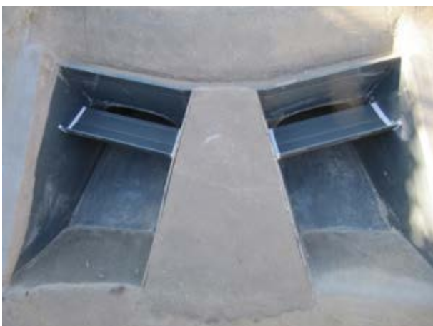
Figure 1 : Prise d'eau sur modèle physique (gauche : Prise d'eau avec une structure de mitigation des vortex, droite : Observation d'un vortex type III)
