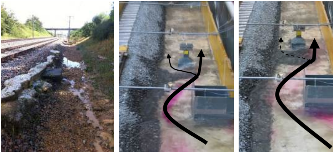
Figure 1 : Gauche: photo prise après l'orage survenu à Sarry en 2000. Centre et droite : Ecoulement entre les obstacles (pile de pont à l'amont et poteau caténaire à l'aval) pour une pente de 3.0% et un débit de 0.24 \text{ m}^2/\text{s} pour une distance de 3.0 m (au centre) et de 4.5 m (à droite)
