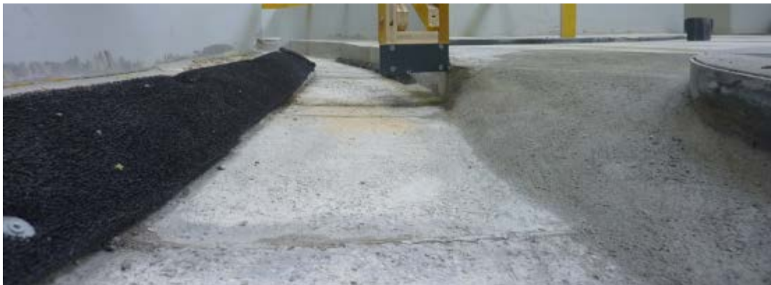
Figure 2 : Vue depuis l'amont de l'ouvrage de contrôle (G2) sur modèle physique
