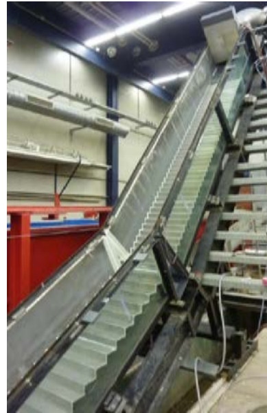
Figure 1 : Modèle physique de déversoir en escalier avec changement de pente abrupt / Physical model of stepped spillway with abrupt slope change.
