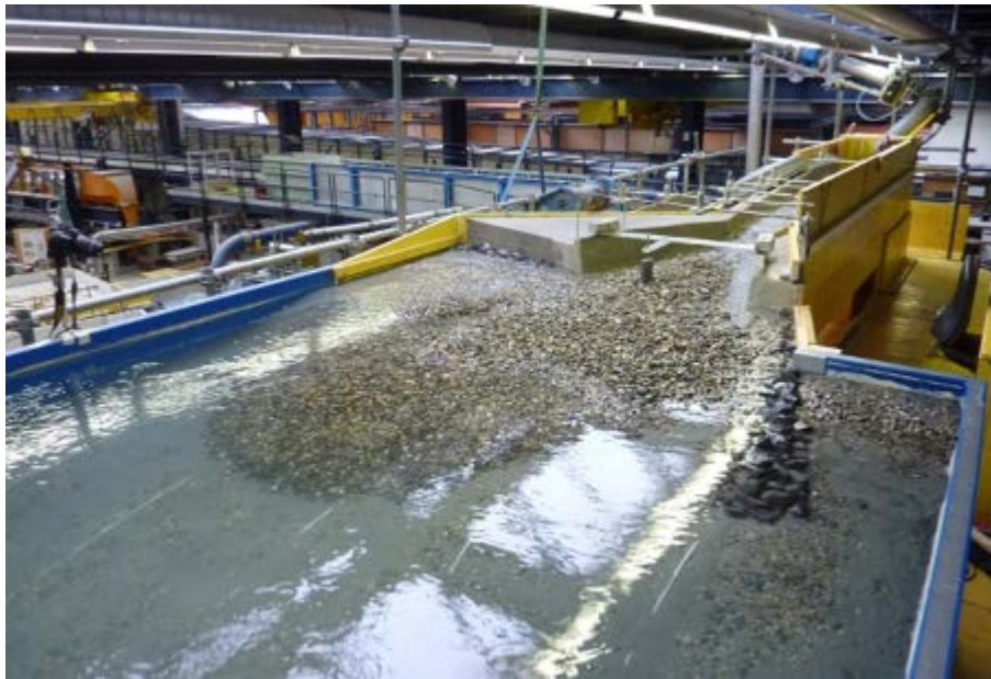
Figure 1 : Modèle physique après une crue tricentennale
