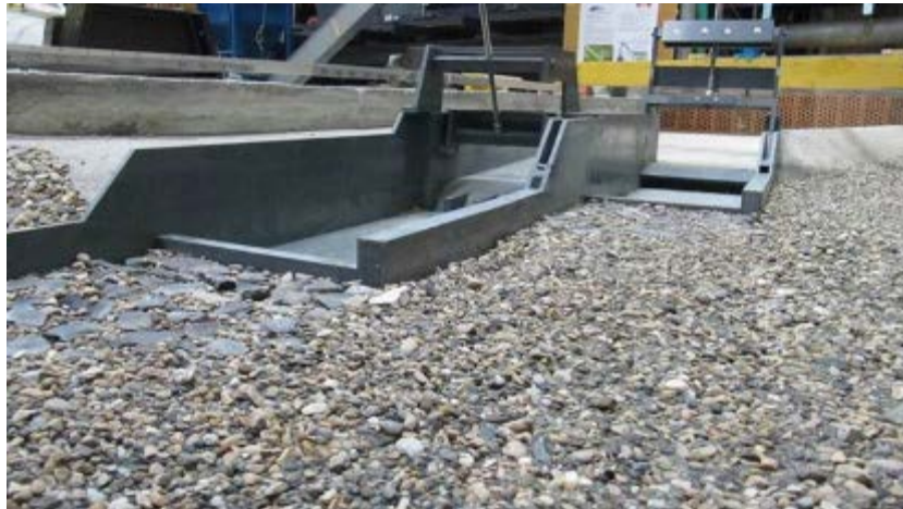
Figure 1 : Modèle physique des organes de sortie – vue depuis l'aval
