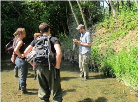
En mission dans la Sorge (à gauche : Joe Rogers explique la récolte des données; à droite : un participant avec le TS, l'instrument pour la mesure de la profondeur et de la vitesse de l'écoulement)
