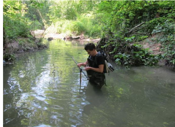
En mission dans la Sorge (à gauche : Joe Rogers explique la récolte des données; à droite : un participant avec le TS, l'instrument pour la mesure de la profondeur et de la vitesse de l'écoulement)
