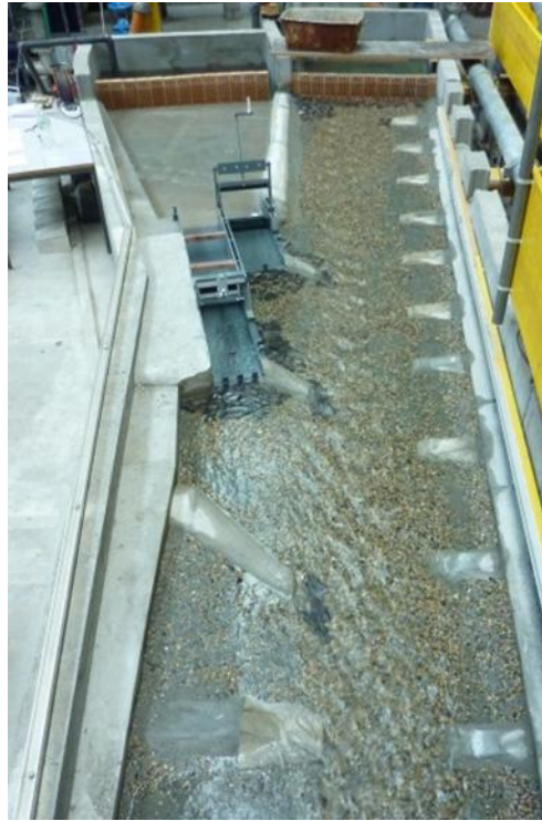
Figure 2 : Modèle physique de l'aménagement et de l'Aare – vue depuis l'aval
