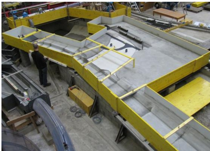
Figure 3 : Modèle physique Sorne-Delémont à l'échelle 1:32, construit sur une plateforme étanche
