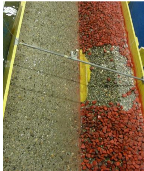
Figure 3 : Vue de défaillance des enrochements / view of riprap failure
