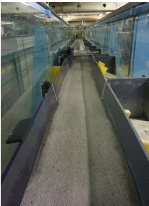
Figure 3 : Modèle physique de la Lizerne – vue depuis l'amont / Physical model of the Lizerne River – viewed from upstream
