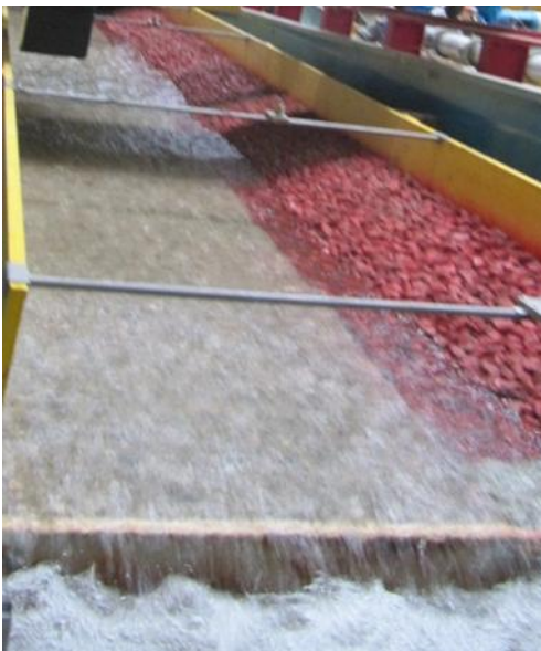
Figure 3 : Vue de défaillance des enrochements / view of riprap failure
