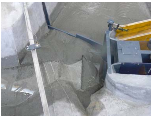
Figure 2: Les dépôts des sédiments retenue par le seuil amont (à gauche) et aval (à droite) / The deposited sediment retained by upstream sill (left) and downstream sill (right)
