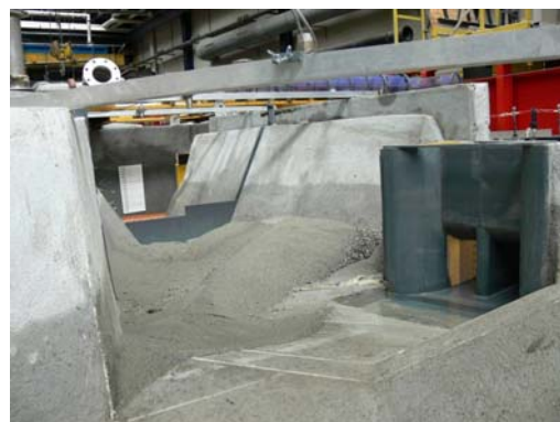
Figure 2: Les dépôts des sédiments retenue par le seuil amont (à gauche) et aval (à droite) / The deposited sediment retained by upstream sill (left) and downstream sill (right)
