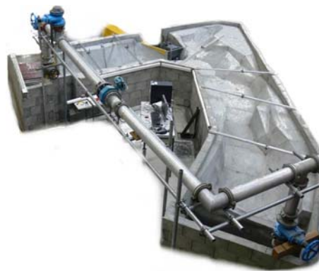
Figure 1: Le modèle physique initialement préparé en 3D environnement numérique (à gauche) et ensuite construit dans le laboratoire (à droite) / The physical model initially prepared in 3D digital environment (left) and afterwards in the laboratory (right)
