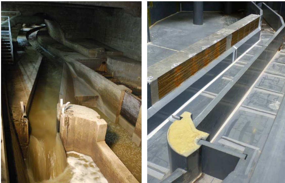
Figure 1 : (a) Le déversoir d'orage du Capelard sur site, et (b) situation de la grille et de l'enceinte de déversement sur modèle réduit / (a) The combined storm overflow Capelard in prototype, and (b) with the trash rack installed on the physical model
