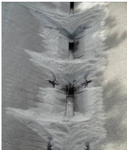
Figure 1: Dépôts des sédiments après la purge (à gauche) et vue des appareils purgeurs (à droite) / The sediment deposit after the flushing (left) and view of the wooden planks (right)
