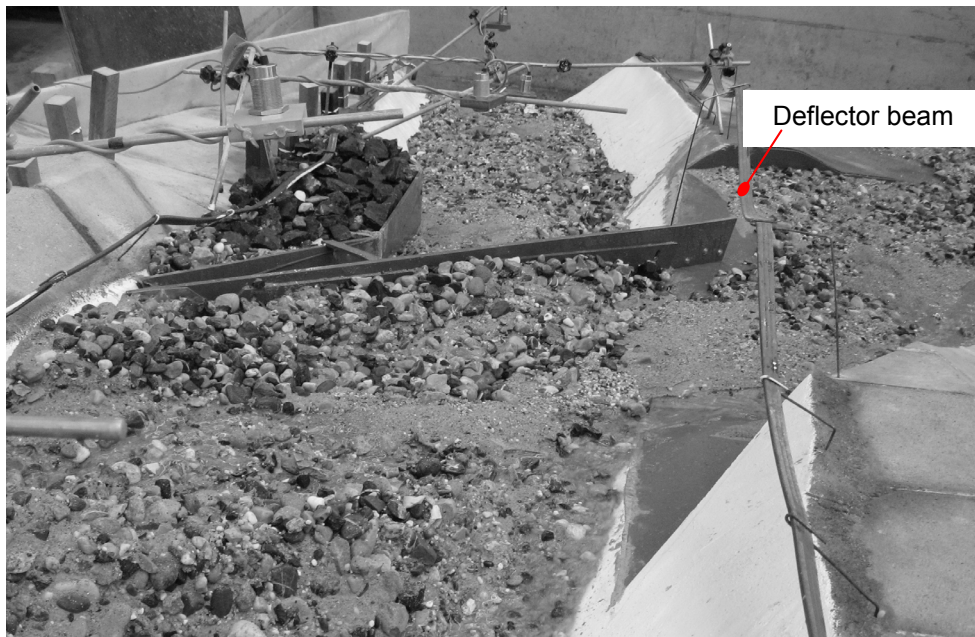
Figure 3 : Photo du modèle prise depuis l'amont montrant les dépôts après le passage de la troisième coulée de lave / Photo of the model taken from the upstream showing the deposits at the end of the third pulse of debris flow
