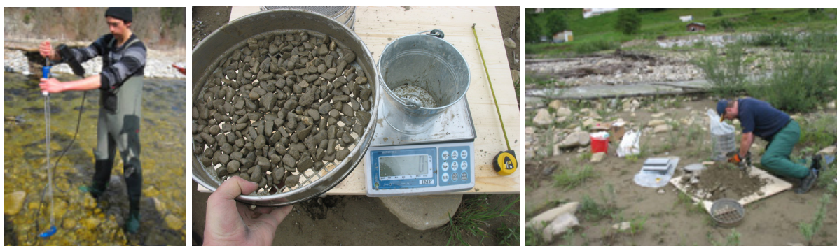
Figure 1 : Mesure de vitesse au site n° 3 (gauche) et analyse par tamisage au site n° 1 (milieu et droite) / Velocity measurements at site n°3 (left) and sieve analysis at site n°1 (middle and right)
