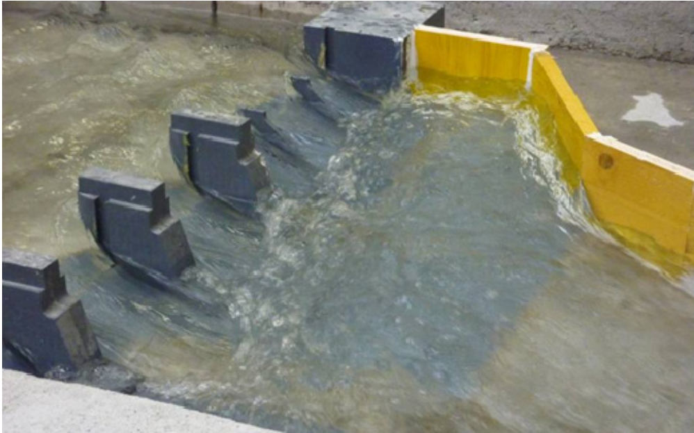
Figure 2 : Ecoulement et ressaut hydraulique de la phase I de construction dans sa géométrie finale avec toutes les passes ouvertes et Q_{20} à la limite d'ennoiement par l'aval / Flow and hydraulic jump for the construction phase I in its final geometry for all gates open and Q_{20} at the limit of downstream submergence
