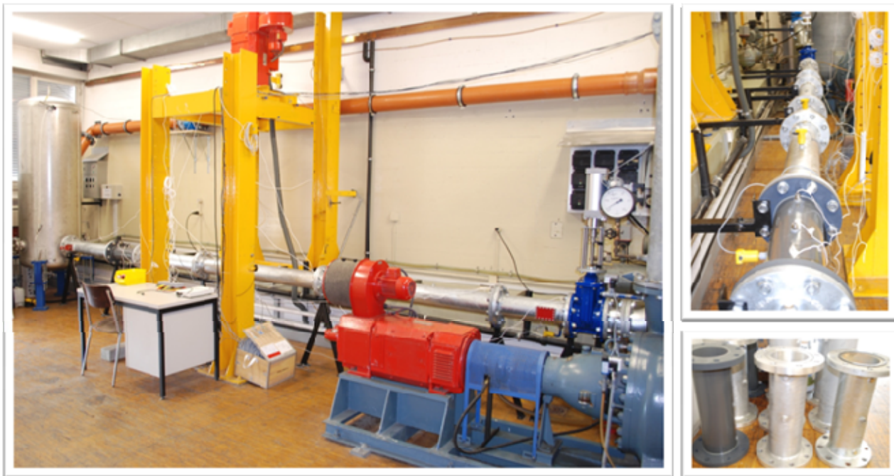
Figure 2: Photos de l'installation physique avec les bouts de conduites en acier, PVC et aluminium / Photos of the physical scaled model with the steel, PVC, and aluminum reaches
