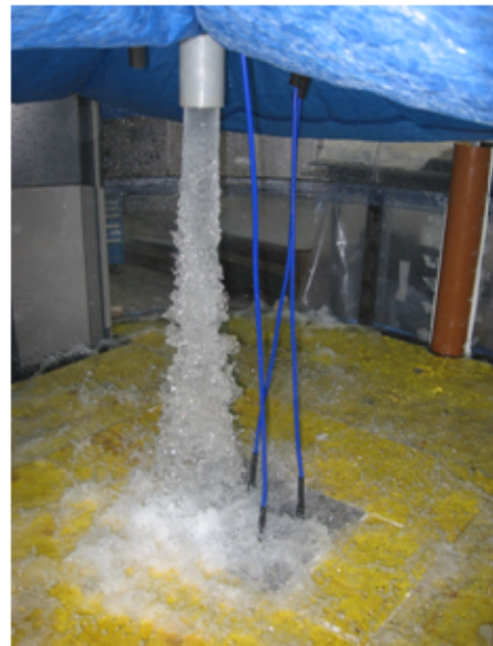
Figure 2: Gauche: Point d'impact au milieu du bloc, hauteur d'eau (Y) 0.1 m et vitesse du jet 7.4 m/s; Droite: Point d'impact au coin du bloc, hauteur d'eau (Y) 0.0 m et vitesse du jet 4.9 m/s / Left: Jet impact point in the middle of the block, water level (Y) 0.1 m and jet velocity 7.4 m/s; Right: Jet impact point on the corner of the block, water level (Y) 0.0 m and jet velocity 4.9 m/s
