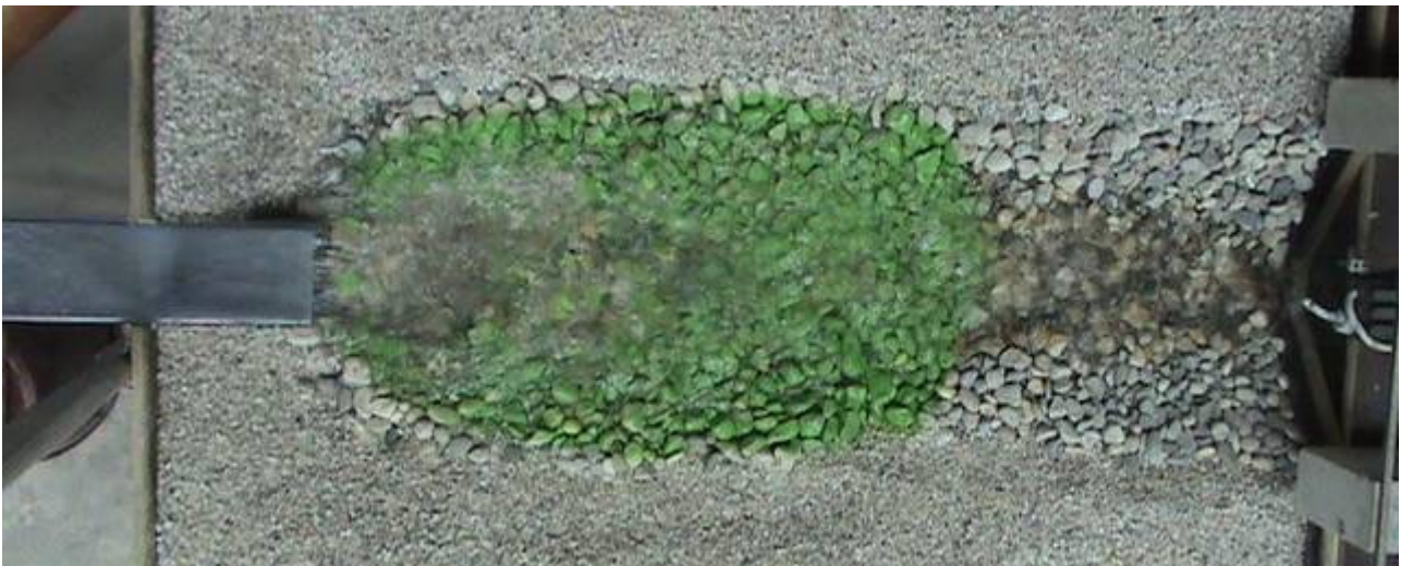
Figure 2 : Modèle hydraulique de l'ouvrage de dissipation / Hydraulic model of stilling basin downstream the tunnel
