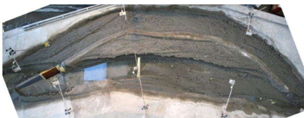
Figure 4 : Alluvionnement à la fin de la crue centennale dans la configuration 1 / Result at the end of the auto-cleaning for configuration 1
