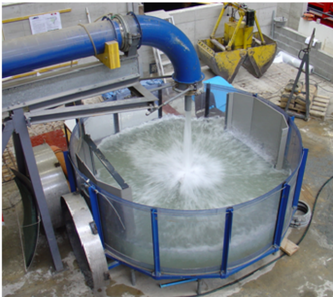
Figure 2: Gauche: Point d'impact au milieu du bloc, hauteur d'eau (Y) 0.1 m et vitesse du jet 7.4 m/s; Droite: Point d'impact au coin du bloc, hauteur d'eau (Y) 0.0 m et vitesse du jet 4.9 m/s / Left: Jet impact point in the middle of the block, water level (Y) 0.1 m and jet velocity 7.4 m/s; Right: Jet impact point on the corner of the block, water level (Y) 0.0 m and jet velocity 4.9 m/s
