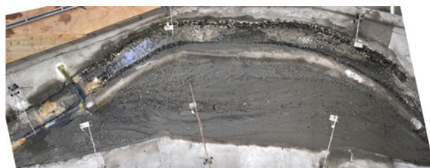
Figure 5 : Résultat à la fin de la crue centennale dans la configuration 6 / Result at the end of the auto-cleaning for configuration 6
