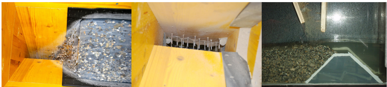
Figure 4 : Distribution optimale de sédiments sur la totalité de la largeur du canal / Optimal distribution of sediments at the inlet of the flume
