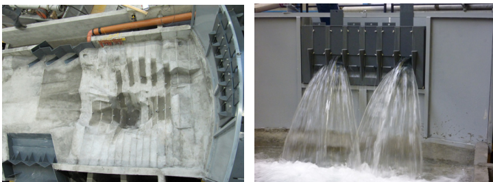
Figure 2 : a) Photos du modèle physique b) Valeurs de débit / a) Photos of the physical model b) Discharge features
