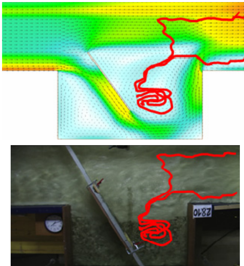
Fig. 2 : Exemples de trajectoires de poissons sur images vidéo et sur champ de vitesses simulées avec Basement 2D (VAW-ETHZ), pour la configuration C3 / Examples of fish trajectories on video images and velocities field simulated with Basement 2D (VAW-ETHZ), for the C3 configuration
