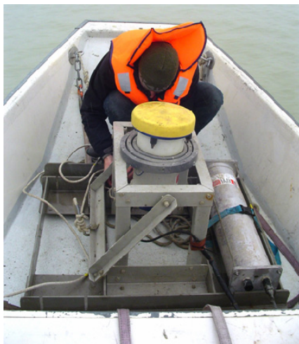
Figure 2 : Préparation de l'instrument de mesure (ADP, à gauche), profil de vitesse en mode turbinage (écoulement sortant, à droite) / Preparation of the measurement device (ADP, left), velocity profile during generating mode (out-flowing discharge, right)
