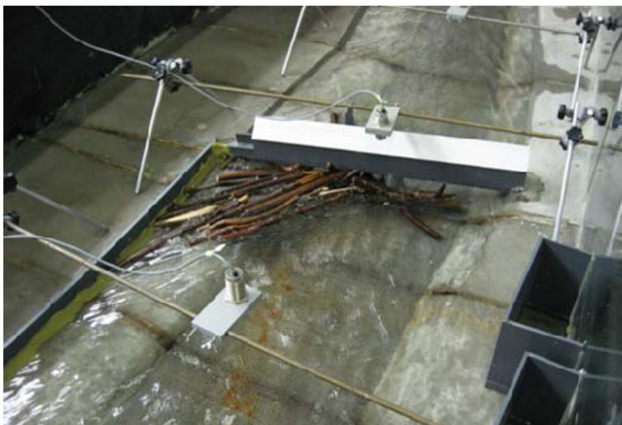
Photo d'une embâcle formée à l'amont du pont par des bois flottants / *Picture of the obstruction by floating wood upstream of the bridge*
