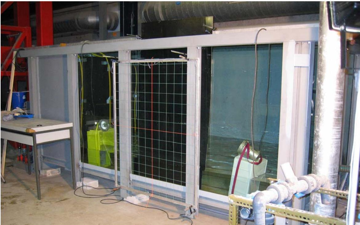
Figure 1: Modèle physique avec l'installation prête pour une mesure PIV (Particle-Image-Velocimetry) afin d'évaluer le coefficient de traînée des "sédiments" (coquilles de noix moulues) utilisés dans les expériences / *Physical model with the installation ready to do PIV (Particle-Image-Velocimetry) in order to evaluate the drag coefficient of the "sediments" (ground nutshells) used in the experiments*
