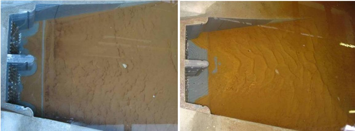
Figure 2: Comportement des sédiments devant les prises d'eau en fonction du mode d'exploitation (gauche: turbinage, droite: pompage) / *Sediments behaviour in front of the intake according to the exploitation mode (left: generating mode, right: pumping mode)*
