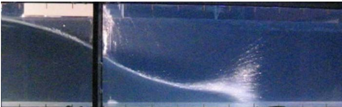
Figure 1 : Essai préliminaire d'onde simple de rupture de barrage / Preliminary test on simple dam break wave
