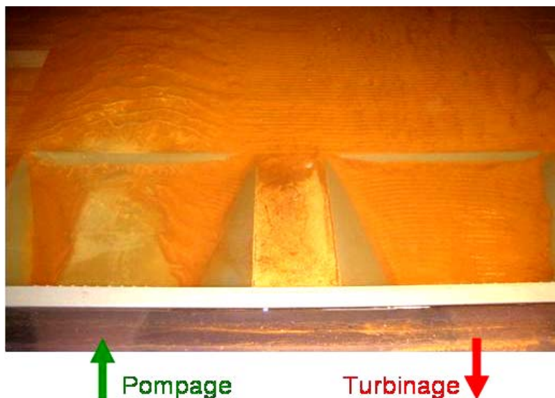
Figure 2 : Comportement des sédiments devant les prises d'eau en fonction du mode d'exploitation / Sediments behaviour in front of the intakes according to the exploitation mode
