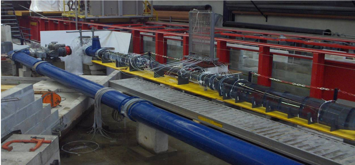
Figure 1 : Éléments du modèle et emplacements des prises de pression / Model joints and pressure measurements locations
