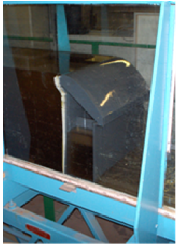
Figure 1 : Maquette du déversoir implantée dans le canal d'essai / Spillway model established in the measuring flume
