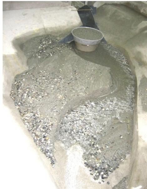
*Figure 2: Fin de l'essai d'érosion du delta en phase de décrue avec et sans corps flottants. / Bed-load trap after an erosion test with and without floating wood for a decreasing flood hydrograph*
