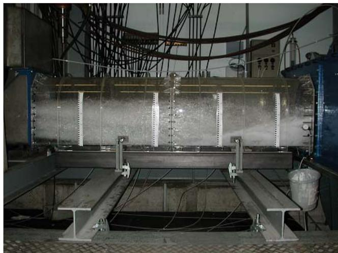
Figure 2: Jet sortant de la vane de vidange de fond et formation d'une *queue de coq* dans le tunnel en aval / *Jet issuing from bottom outlet gate and formation of rooster tail in the downstream tunnel*
