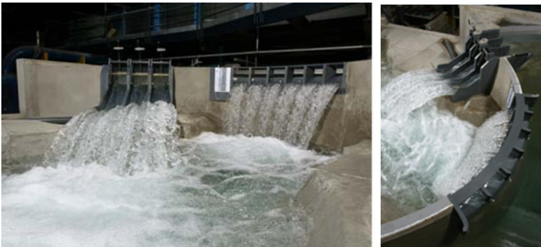
Figure 1 : modèle physique du barrage Shahryar avec ses deux évacuateurs de crues / *physical model of the Shahryar dam with its two spillways*
