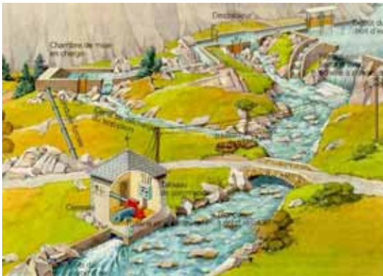
Figure 1: Composants principaux d'un petit aménagement hydroélectrique / Main components of a small hydropower plant
