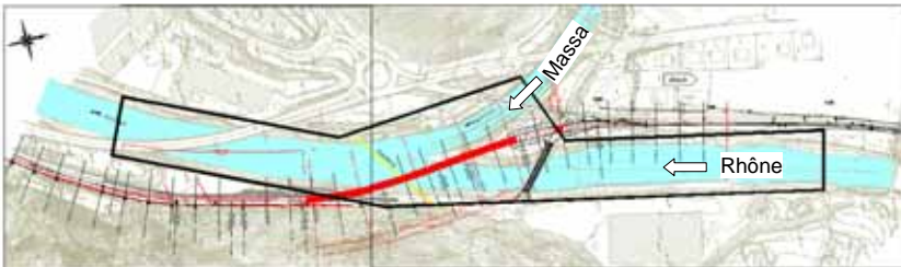
Figure 1 : Zone de confluence du Rhône et de la Massa avec le tracé du pont projeté et les limites reproduites sur le modèle physique / Confluent zone of the Rhone and Massa Rivers with the layout of the planned bridge and the limits reproduced on a physical scale model
