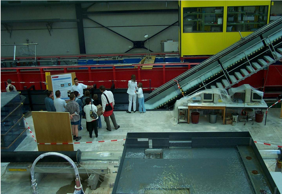
Figure 1: Installation de recherche sur la dissipation d'énergie des écoulements à hautes vitesses et au premier plan modèle physique pour l'étude du système d'évacuation des eaux d'incendie du tunnel du Lötschberg (Mandat de services) / Experimental facility for the study of energy dissipation of high velocity aerated flows and physical model for the study of the drainage system of the tunnel of Lötschberg for the water in case of fire
