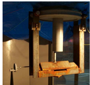
Figure 1 : Installation expérimentale utilisée pour l'étude des caractéristiques du jet à la sortie / Experimental set-up used for the study of jet take-off conditions
