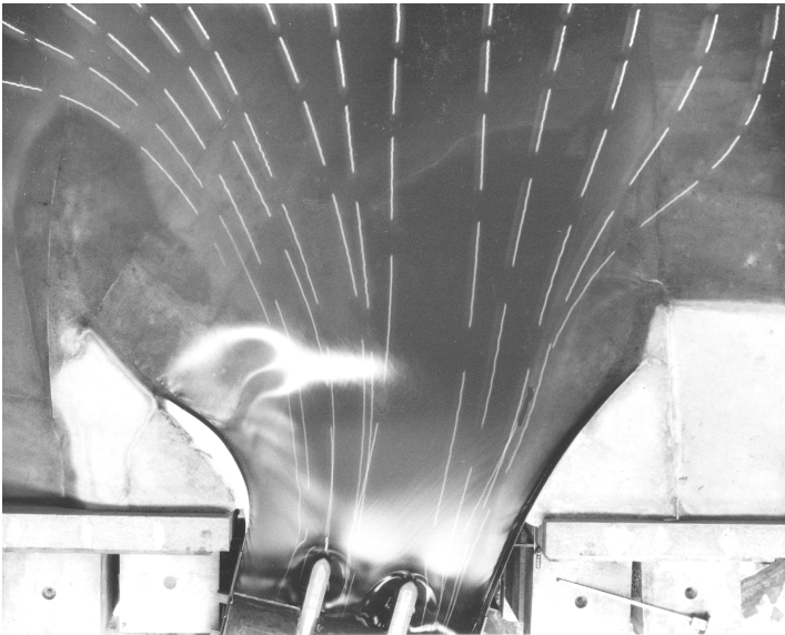
Figure 2: Visualisation des courants d'approche avec des bougies flottantes à l'amont du déversoir pour les trois pertuis complètement ouverts et au niveau maximum d'exploitation / Visualisation of the approach flow currents using floating candles upstream of the three fully open gates weirs with maximum reservoir exploitation level
