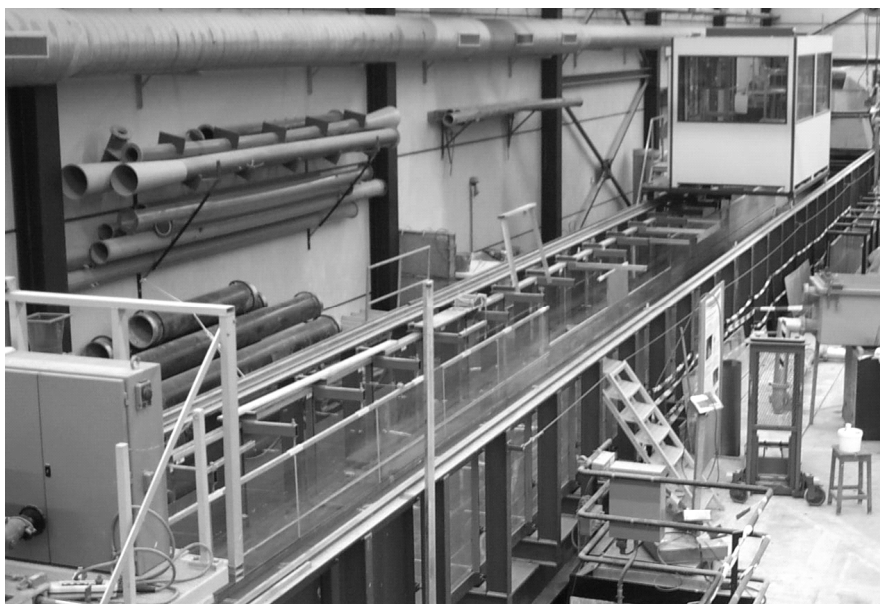
Figure 2: Canal "Vevey" d'une longueur de 42 m utilisé pour les essais systématiques / Test flume "Vevey" for systematic model tests (length 42 m, width 2m)
