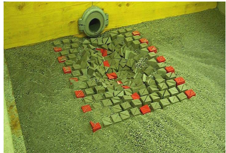
Figure 2: Gauche: Erosion du lit alluvial, droite: prismes de protection / left: Scour hole in alluvial bed, right: protection prisms ( Q=12.5 l/s)
