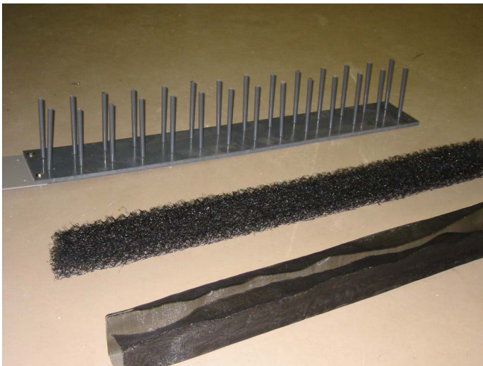
Figure 1: Construction de la maquette du barrage à claire-voie à l'échelle 1 : 1 / The physical model of brushwood fences scaled at 1 : 10
