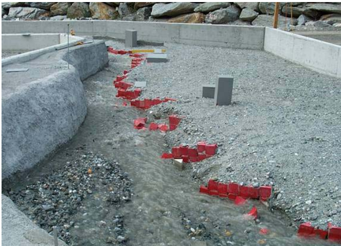
Figure 2: Le modèle physique et les mesures de protection à l'échelle 1:35, lors d'un essai avec un débit de 130 \text{ m}^3/\text{s} (2 fois le débit de la crue 2000) / The physical model (1:35) and the protection measures during a test with a flow of about 130 \text{ m}^3/\text{s} (2 times the flow of the year 2000 flood)
