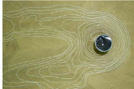
Figure 2: Fosse d'érosion relevée autour d'une pile / Scouring around a bridge pier
