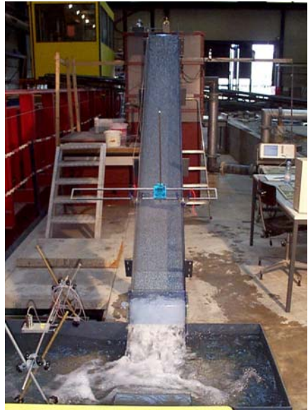
Figure 4: A gauche: Descente d'eau pluviale en escalier type DE04 à Avignon (France), à droite: Modèle réduit de la descente lisse type DE03 / Left: The stepped energy dissipating structure type DE04 at Avignon (France). Right: The physical model of the smooth energy dissipating structure type DE03.
