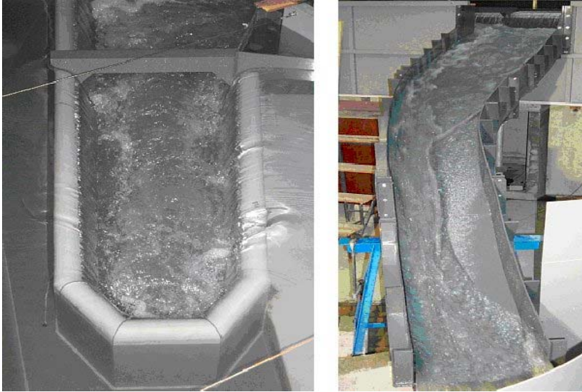
Figure 1: Gauche: Déversement dans l'auge, légères perturbations en rive droite (Q=74m 3 /s) / Left side: Lateral overflow, minor flow disturbances on the right bank (Q=74m 3 /s) Droite: Ecoulement sur le coursier, ondes de chocs (Q=74m 3 /s) / Right side: Flow on the spillway, shock waves (Q=74m 3 /s)
