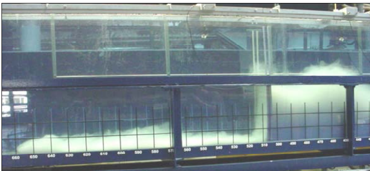
Figure 1: Expérience d'un courant de turbidité passant à travers une grille verticale / Experiment of turbidity current flowing through a vertical screen
