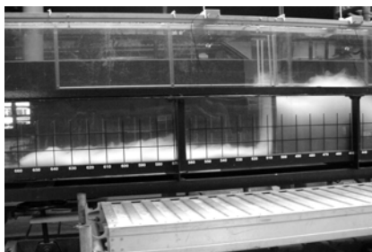
b) Courant de turbidité passant à travers un géotextile perméable / Turbidity current passing through a permeable fence
