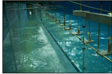
Figure 2 : Photo de l'installation d'essai (gauche) et du déversoir latéral (droite) / Photo of the experimental installation (left) and of the side weir (right)
