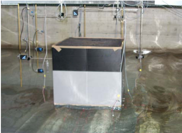
Figure 1: Mesure des mouvements du Monolithe face aux vagues dans le bassin à houle du LCH / Wave-induced movement measurements of the Monolith in the wave tank of the LCH
