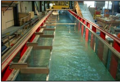
Figure 2 : Photo de l'installation d'essai (gauche) et du déversoir latéral (droite) / Photo of the experimental installation (left) and of the side weir (right)
