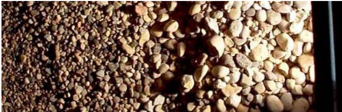
Figure 4: Distribution granulométrique à l'extérieur (à droite) de la courbe dans une fosse d'érosion / Grain size distribution at the outer side wall of the bend (right)
