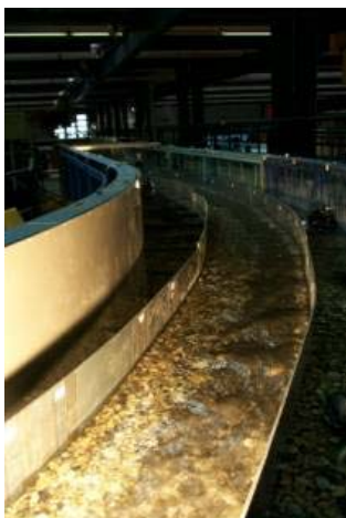
Figure 1: Essai avec banquette en rive droite / Right bank bed overelevation simulation
