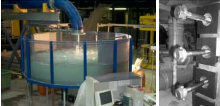
Fig. 1 : Photo de l'installation d'essais (gauche) et des barres de précontrainte (droite) Photo of the experimental installation (left) and of the prestressed steel bars (right)
