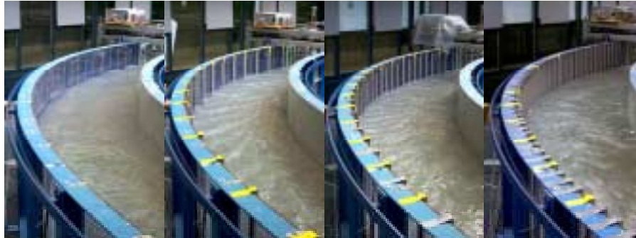
Fig. 2: Photo de l'écoulement dans le canal sans nervures et avec des espacements de 4^\circ , 2^\circ , et 1^\circ Picture of the flow in the channel without ribs and with a spacing of 4^\circ , 2^\circ and 1^\circ
