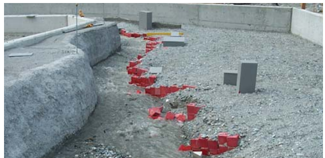
Fig. 3: La Gamsa durant un essai avec un débit de 150 \text{ m}^3/\text{s}
