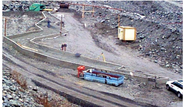
Fig. 2: Vue générale du modèle construit in situ; longueur 70 m
