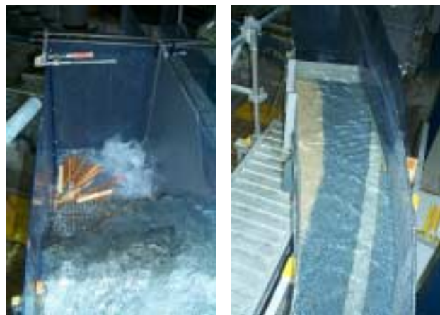
Fig.4 : Test avec corps flottants sur la grille (gauche) et dépôt de sédiments à l'amont du déversoir (droite)
