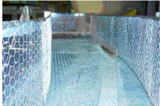
Fig.2 : Chenal d'approche avec rugosité artificielle à l'aide d'un filet
