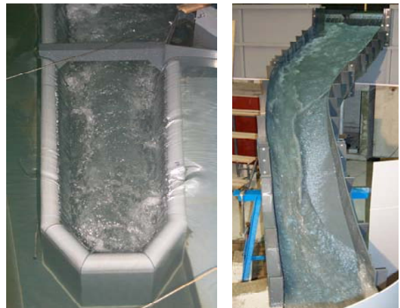
Fig. 3 : A gauche : Déversement dans l'auge, perturbations en rive droite. A droite : Écoulement sur le coursier, ondes de chocs.
