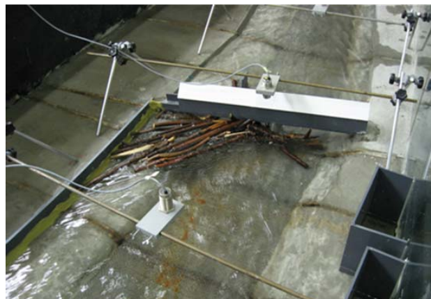
Bild 2: Aufnahme des physikalischen Modells mit Holzansammlung an der Wylenerbrücke
