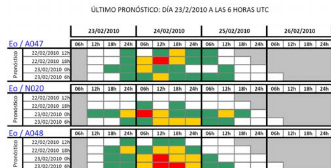
Figure 3: Exemple du bulletin automatique des prévisions hydrologiques aux trois points de contrôle du bassin de l'Eo.
