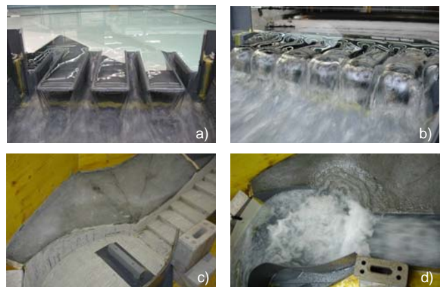
Figure 3 : Modèle physique a) PK-Weir à 4 et b) à 7 alvéoles c) bassin amortisseur sec et d) en charge (ressaut hydraulique)
