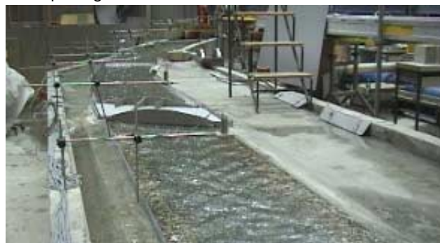
Fig. 1: Partie amont du modèle physique, comprenant les ponts CFF et de la route cantonale.
