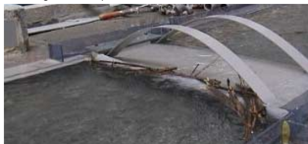
Fig. 2: Pont de la route cantonale lors d'un essai avec corps flottants.
