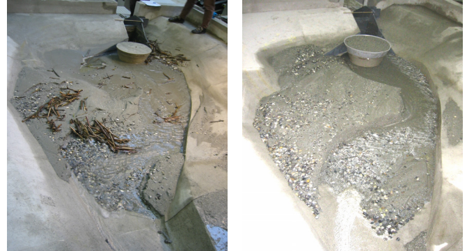
Abb. 2: Geschiebesammler nach Ende eines Erosionsversuchs mit und ohne Treibholz bei abklingender Hochwasserwelle.
