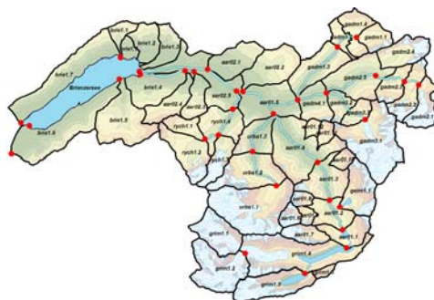
Figure 2: Découpage du bassin de l'Aar en 48 bassins versants, 31 jonctions et 24 tronçons de cours d'eau
