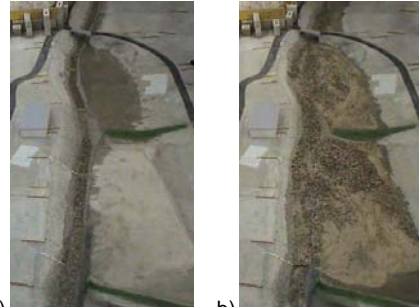
Abbildung 3 : Draufsicht auf das hydraulische Modell im LCH a) ohne und b) mit Ablagerungen (Jahrhunderthochwasser)
