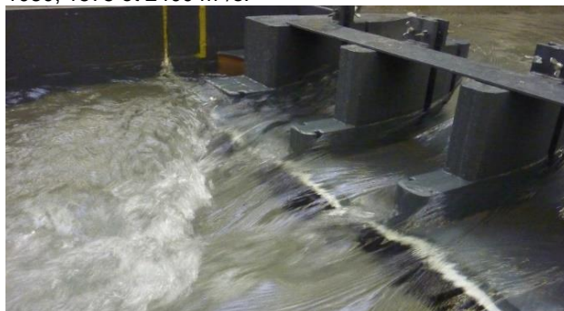
Figure 3 : Recirculation dans la fosse créée à l'aval du barrage mobile suite à l'érosion ( Q = 2400 \text{ m}^3/\text{s} )
