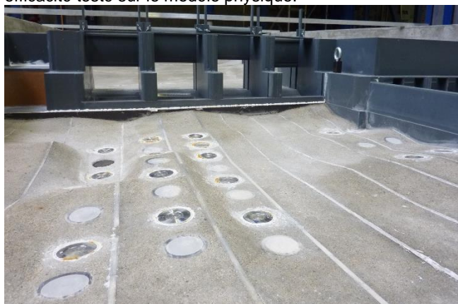
Figure 2 : Modèle physique du barrage de Chancy-Pougny avec des capteurs de pression dans la fosse de dissipation ; usine hydroélectrique à droite
