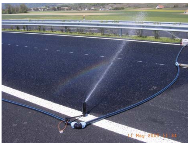
Figure 1: Détail de l'installation d'arrosage avec la buse d'angle interchangeable pour régler l'intensité d'arrosage
